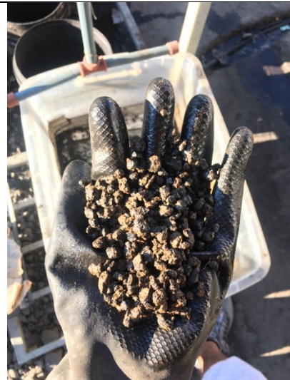
18. Piroclasto volcánico al terminar los 90 días de filtración
