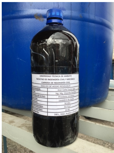
17. Recolección de muestra en botella de vidrio ámbar para análisis físico-químico
