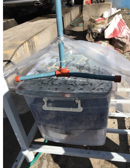
12. Piroclasto volcánico filtrando aguas residuales
