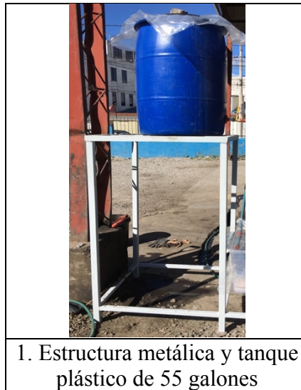
Figura 5: Soporte metálico de filtro biológico
