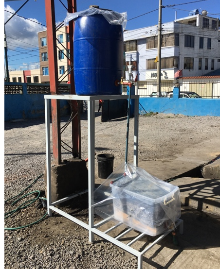
10. Filtro biológico en funcionamiento
