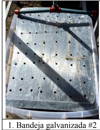
Figura 7: Bandeja agujerada de tol galvanizado
