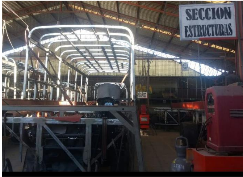
Gráfico 10 Sección Estructura Cepeda Cía. Ltda. Fuente: Autor
