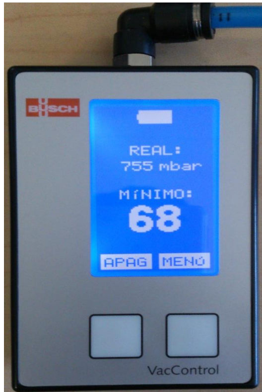
Figura 9.- Medición de presión por medio de vacuómetro digital. Fuente: El autor.
