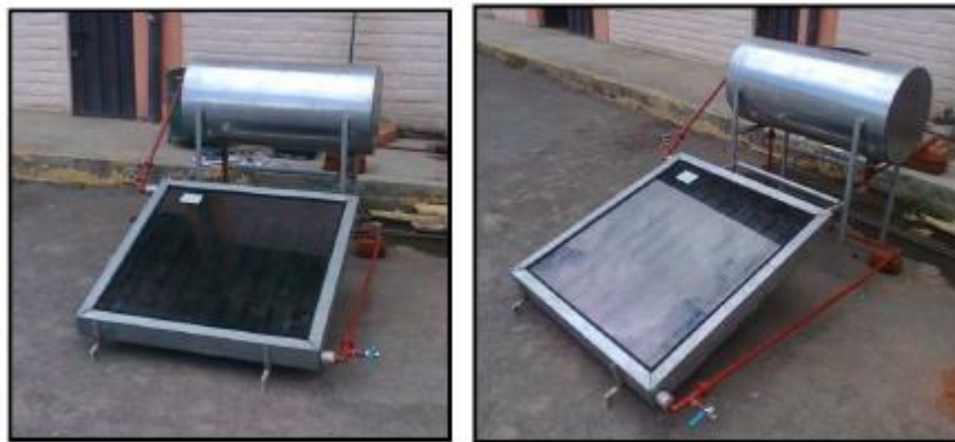
Figura 7. Colector Solar Plano con de Circulación Natural para calentamiento de Agua
