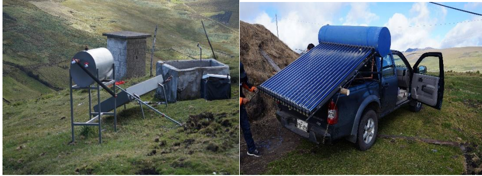
Figura 37. Transporte de los sistemas de ACS (Tubos al vacío, Cilindro parabólico compuesto)
