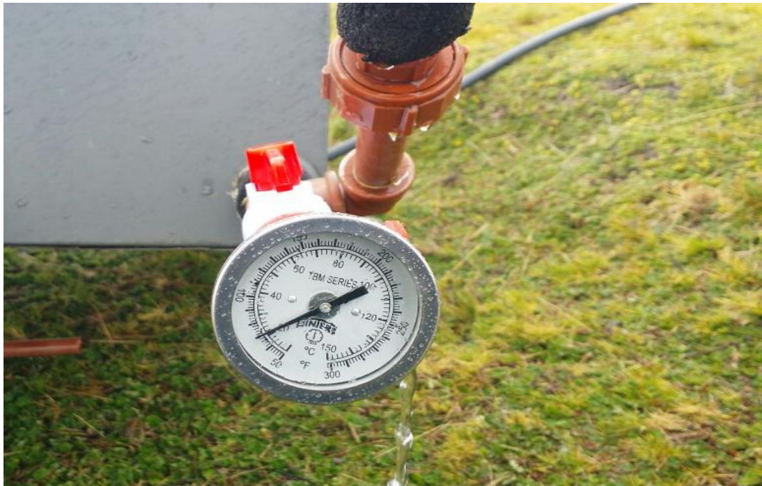
Figura 45. Temperatura de salida con el sistema cilindro parabólico en un día nublado
