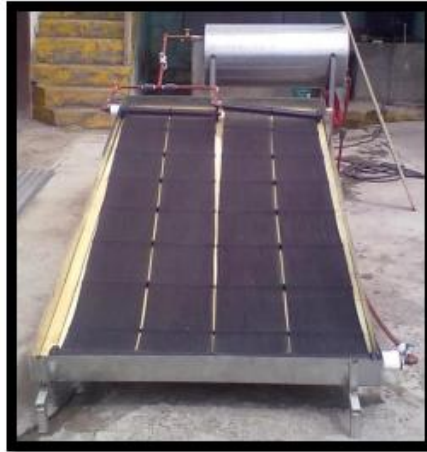
Figura 9. Calentador Solar de Tubos de Propileno
