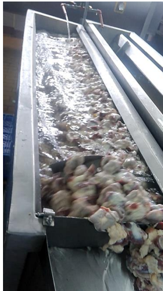
Figura 2.50 Lavado automatizado de mollejas. Fuente: (El autor)
