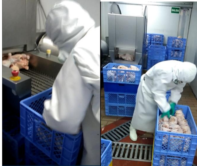
Figura 2.56 Ingreso y salida del pollo de la máquina de marinar. Fuente: (El autor)
