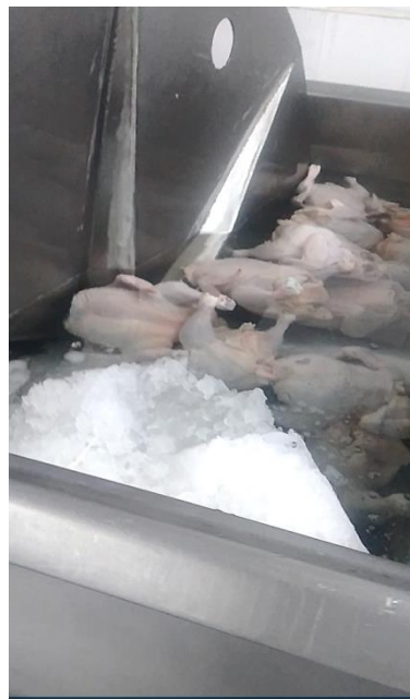
Figura 2.54 Enfriamiento de los pollos en el chiller Fuente: (El autor)
