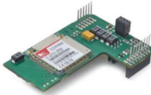
Figura 21. Módulo GPRS+GPS Sim908 [31]
