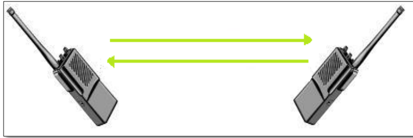
Figura 11: Comunicación Full Dúplex.
