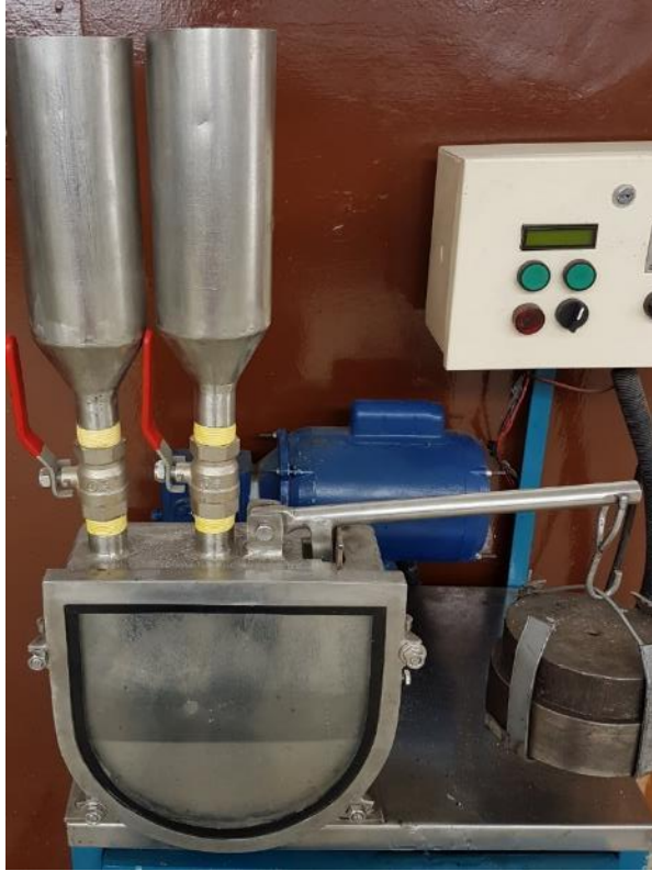
Gráfico 44. Ensayo de Desgaste abrasivo según Norma ASTM G105-89, con carga 222N. Fuente: El autor
