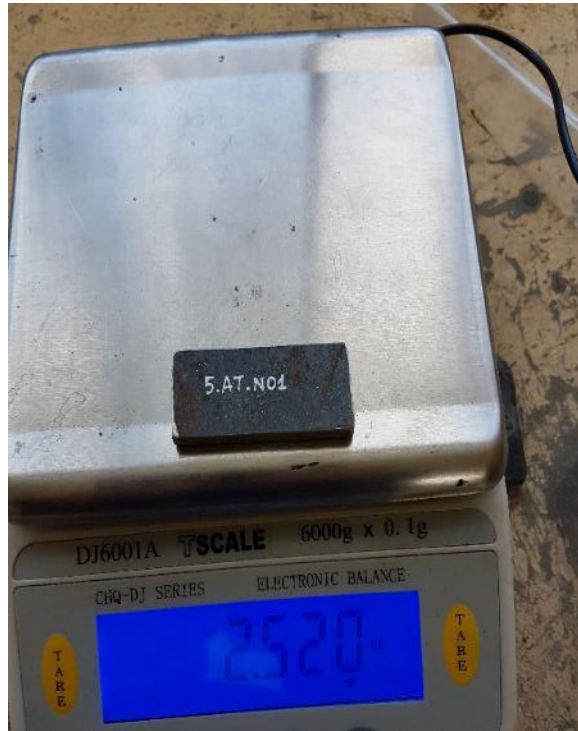
Gráfico 40. Obtención del peso de las probetas, previo al ensayo de desgaste abrasivo. Fuente: El autor
