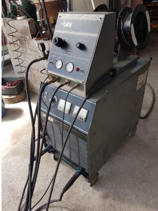
Gráfico 23. Máquina de metalizado TAFSA Arc Spray 8830, de proyección térmica por arco eléctrico.
