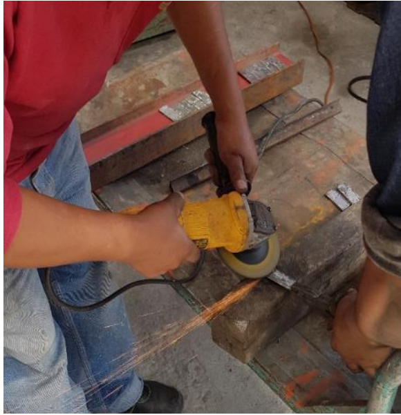
Gráfico 24. Preparación de las probetas mediante pulido y desbaste de las superficies previo a la aplicación del revestimiento metálico.
