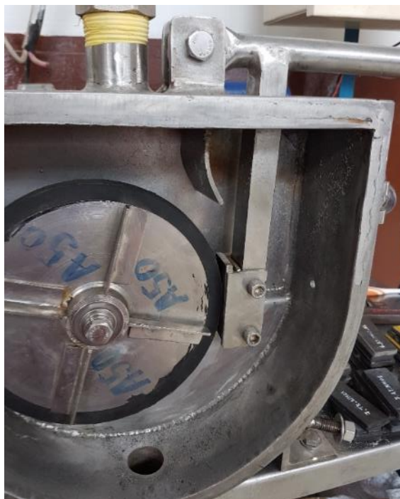
Gráfico 41. Colocación del disco de Neopreno shore A50, en la cámara. Fuente: El autor
