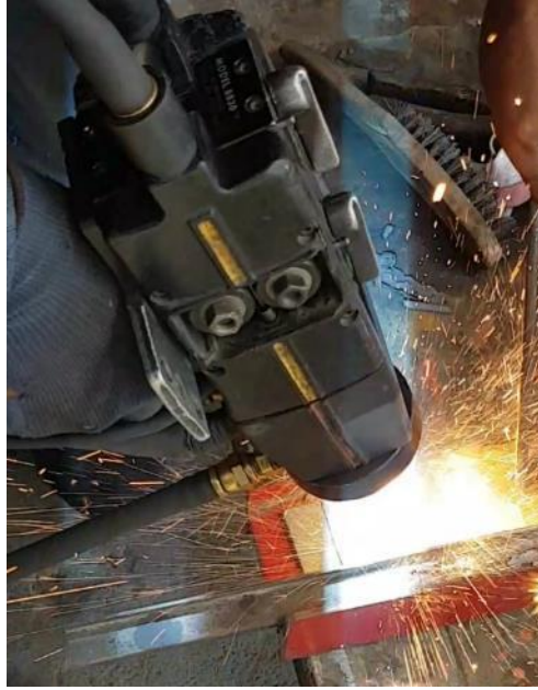
Gráfico 29. Proyección térmica de metal por aspersión de partículas, revestimiento aleación de tungsteno amorfo. Fuente: El autor
