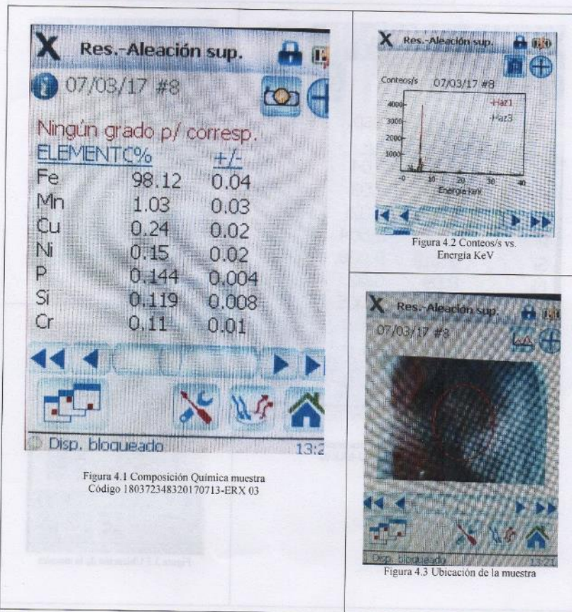
Cuadro 4. Registro para reporte de composición química por Fluorescencia de Rayos X (XRF) por energía dispersiva (ED). Orden No. 8, 03 de julio de 2017. Laboratorio de NDT CFPMC.
