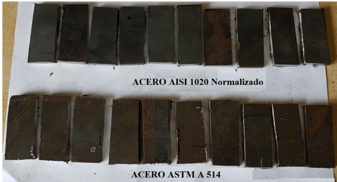
Gráfico 22. Probetas, a) acero AISI 1020 y b) acero ASTM A514, material sin recubrimientos, ni tratamientos térmicos.
