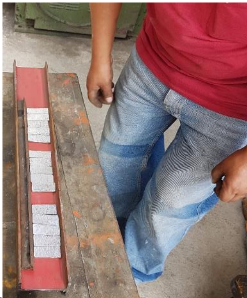
Gráfico 25. Colocación y sujeción de las probetas para la aplicación de la capa base de aluminio por metalización.
