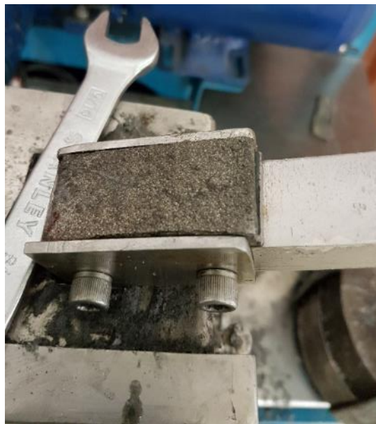
Gráfico 43. Colocación de probeta en porta especímenes, muestra con revestimiento metalizado de base Aluminio en Acero AISI 1020. Fuente: El autor
