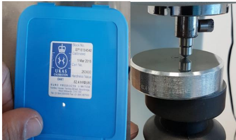
Gráfico 39. Patrón de calibración UKAS de Durómetro ERNST NR 3D, dureza calibrada: 82.4HRB
