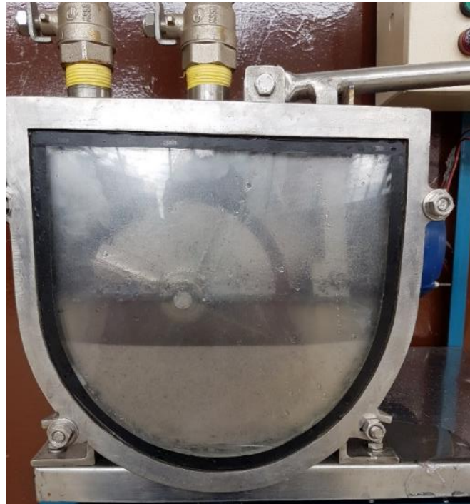
Gráfico 42. Llenado de mezcla agua y arena silícica en la cámara hermética. Fuente: El autor
