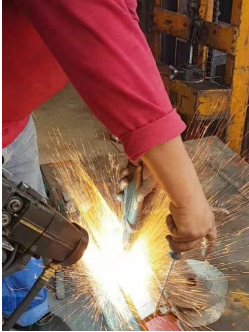
Gráfico 26. Proyección térmica de metal por aspersión de partículas, revestimiento base Aluminio. Fuente: El autor
