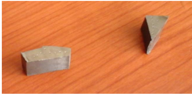
Figura 4. 21 Análisis de dureza de las chumaceras, probeta 1 y 2, análisis realizado en laboratorio de materiales FICM-UTA.
