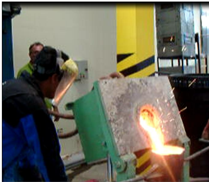
figura 6. 14. Descarga del horno de inducción, ESPOCH.
