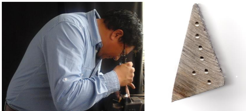
figura 6. 38. Medición las indentaciones del ensayo de dureza Brinell en el laboratorio de materiales FICM UTA, Izquierda medición de grano con objetivo escalado micrométricamente, derecha fotografía del barrido de dureza en la probeta.
