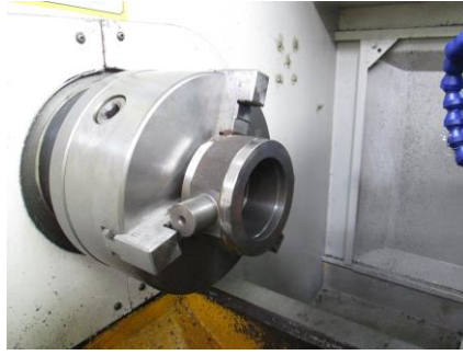
figura 6. 24. Elemento mecanizado montado en el torno de CNC.
