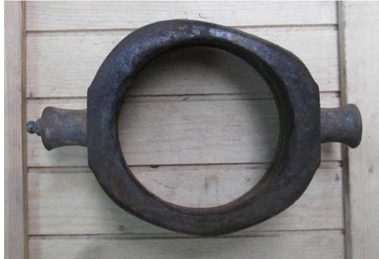
figura 6. 11. Imagen de la chumacera desgastada al espesor de falla (5mm de espesor).
