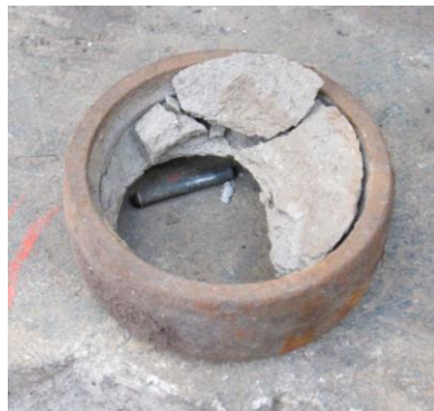
Figura 4. 22. Pista de rodamiento llena de tierra al desarmar una chumacera.
