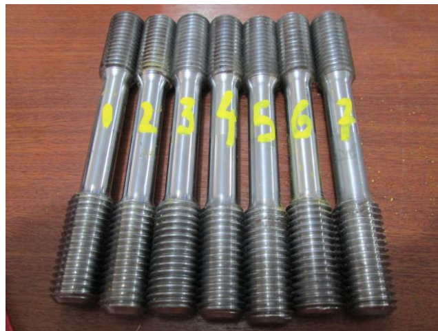
figura 6. 29. Probetas construidas para el ensayo de tracción
