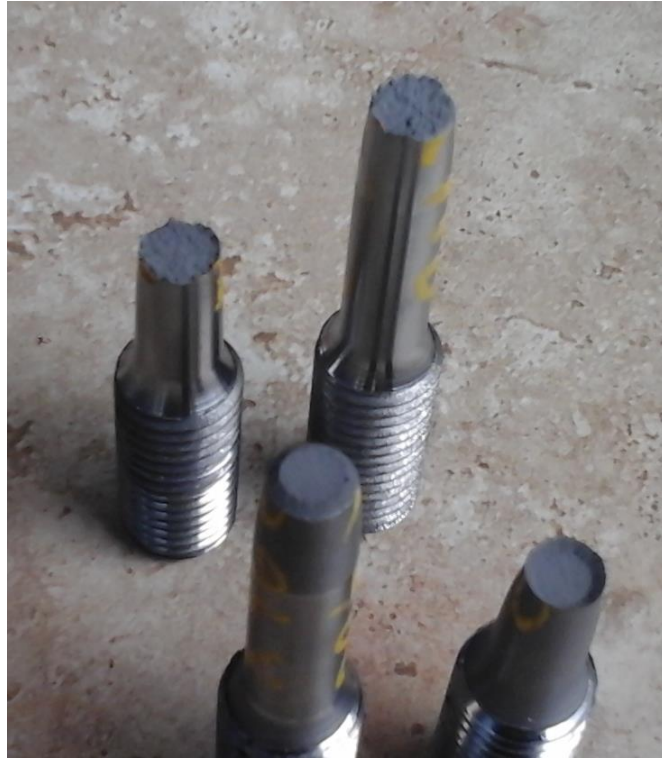
figura 6. 37. Diferencia entre la fractura dúctil del acero de bajo carbono (abajo) y nuestra fundición al manganeso con su fractura frágil (arriba).
