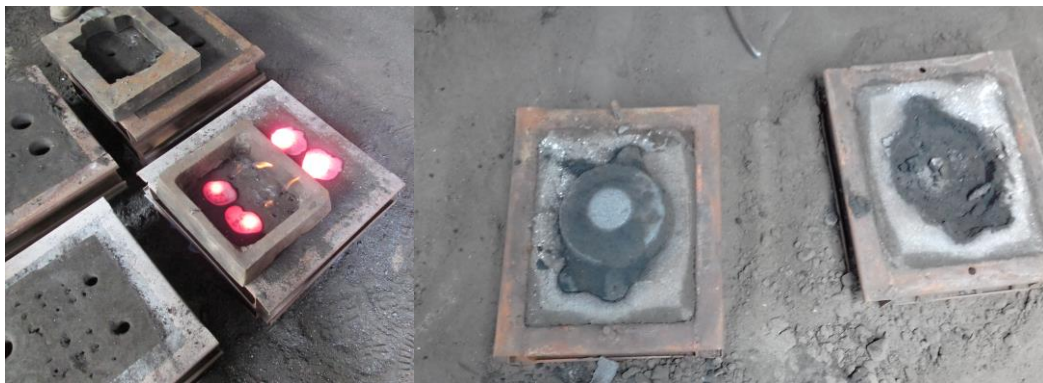
figura 6. 21. Vista del elemento recién colado ya fundido
