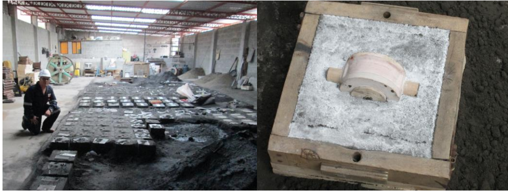
figura 6. 20. Se puede apreciar el área de preparación de las cajas para el colado del material a la izquierda y el modelo en la caja de arena verde a la derecha.
