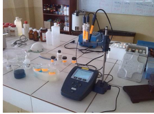
Ilustración 17. Equipo Multiparamétrico Para Medición de Ph, Conductividad, Oxígeno Disuelto
