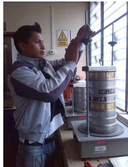
Ilustración 4. Tamizado de la Arena Separación de Limos y Arcillas.
