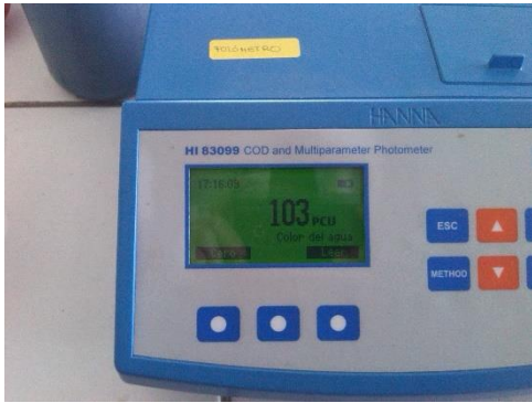
Ilustración 18. Lectura de Color en Fotómetro
