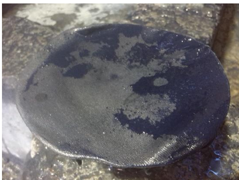
Ilustración 14. Materia retenida en un filtro de Toldo
