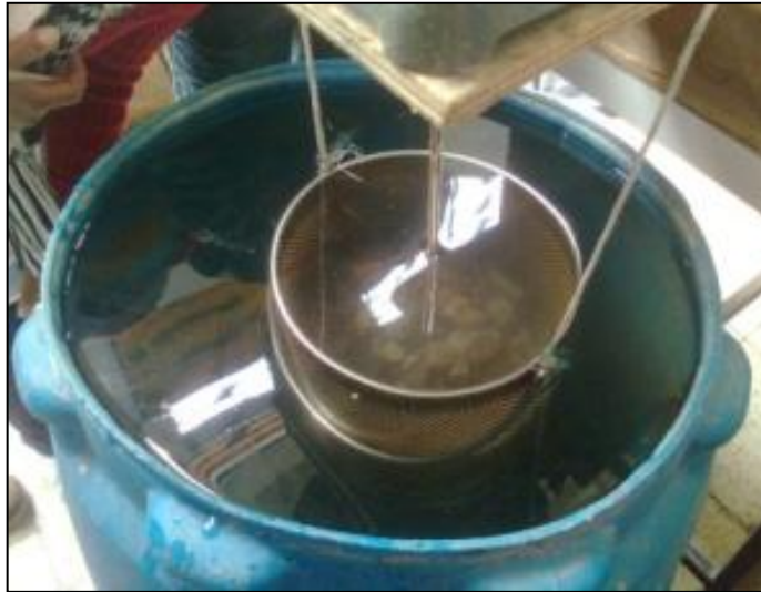
Imagen 10. Muestra de ripio sumergida para determinación de la densidad real del ripio.
