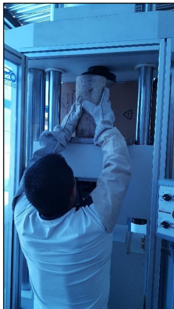
Imagen 21. Colocación de probeta después del choque térmico en la maquina universal METROTEC y Ceteo de la misma en el laboratorio de Ensayo de Materiales del CENTRO DE FOMENTO PRODUCTIVO METALMECANICO CARROCERO del HONORABLE GOBIERNO PROVINCIAL DE TUNGURAHUA, para el ensayo de compresión de hormigón.
