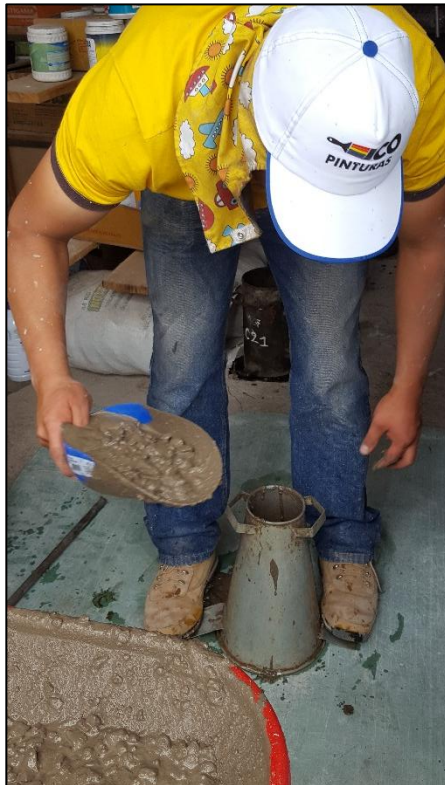
Imagen 11. Llenado de cono de Abrams para chequeo de asentamiento de una de las mezclas desarrolladas..
