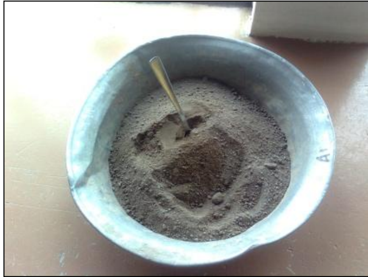
Imagen 8. Muestra de Arena en recipiente metálico para la determinación de sus propiedades granulométricas.
