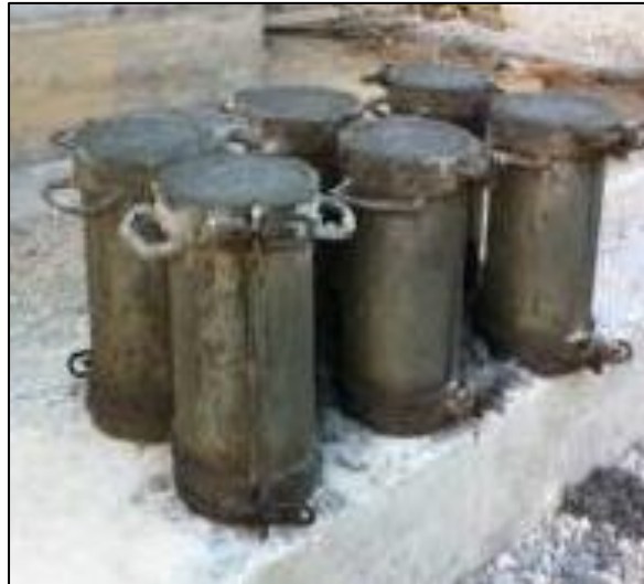
Imagen 3. Probetas de Hormigón
