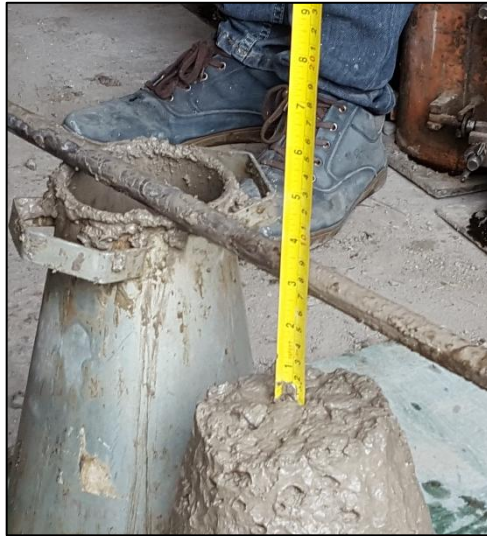
Imagen 12. Medición del asentamiento de la mezcla de hormigón tradicional en el cono de Abrams..
