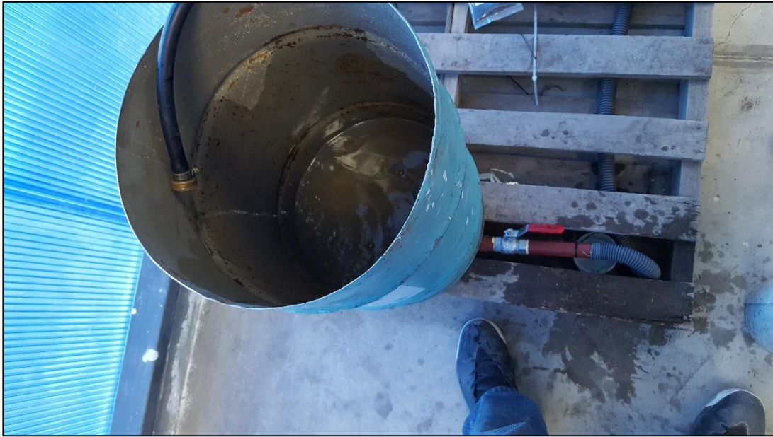
Imagen 18. Tanque de recirculación de agua; para el choque térmico de las probetas.
