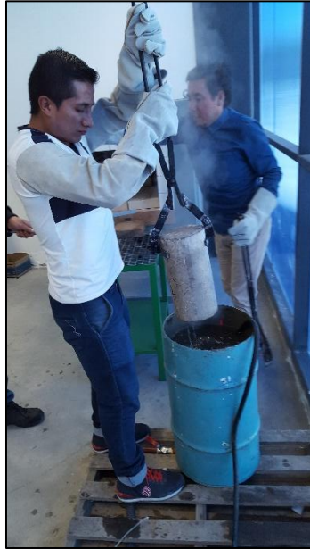
Imagen 20. Choque térmico de probeta a 500 °C.
