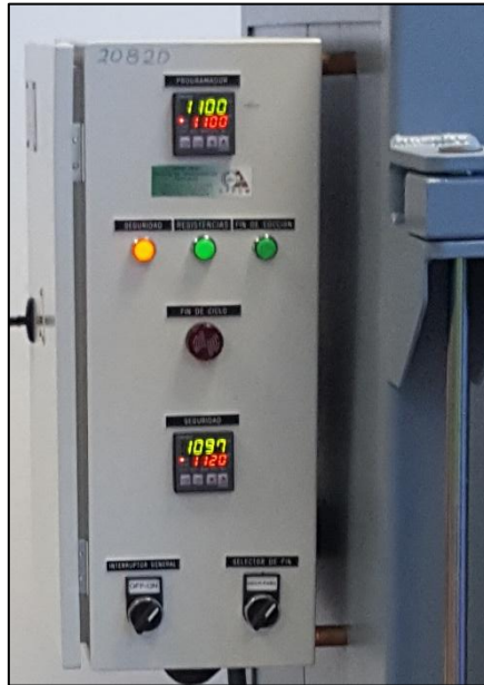
Imagen 24. Controlador de temperatura alcanzando la temperatura de 1100 °C.
