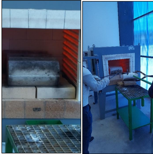
Imagen 22. Extracción de probetas del Horno de tratamientos térmicos con Pirómetro en el laboratorio de Ensayo de Materiales del CENTRO DE FOMENTO PRODUCTIVO METALMECANICO CARROCERO del HONORABLE GOBIERNO PROVINCIAL DE TUNGURAHUA a una temperatura de 700°C.
