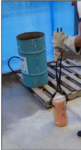
Imagen 26. Probeta a 1100 °C antes del choque térmico con agua a temperatura ambiente.
