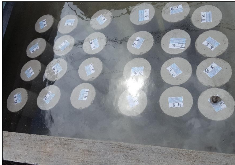
Imagen 13. Cilindros de las diferentes mezclas etiquetados y sumergidos en la piscina de Curado.
