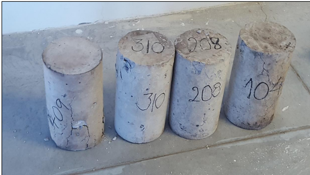
Imagen 23. Fractura típica de las cuatro diferentes mezclas.
