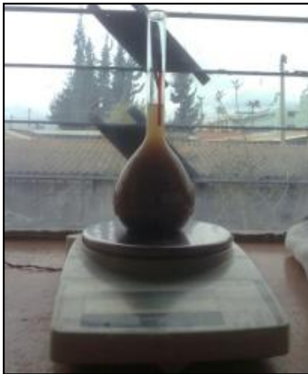
Imagen 9. Picnómetro utilizado para la determinación del contenido de humedad del agregado fino.
