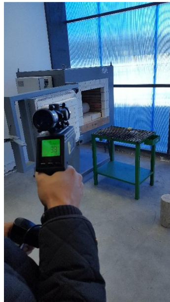
Imagen 19. Medición de la temperatura interna inicial del Horno de tratamientos térmicos con Pirómetro en el laboratorio de Ensayo de Materiales del CENTRO DE FOMENTO PRODUCTIVO METALMECANICO CARROCERO del HONORABLE GOBIERNO PROVINCIAL DE TUNGURAHUA.
