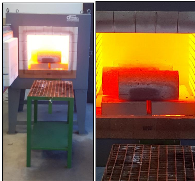
Imagen 25. Apertura a 1100 °C del Horno de tratamientos térmicos con Pirómetro en el laboratorio de Ensayo de Materiales del CENTRO DE FOMENTO PRODUCTIVO METALMECANICO CARROCERO del HONORABLE GOBIERNO PROVINCIAL DE TUNGURAHUA.
