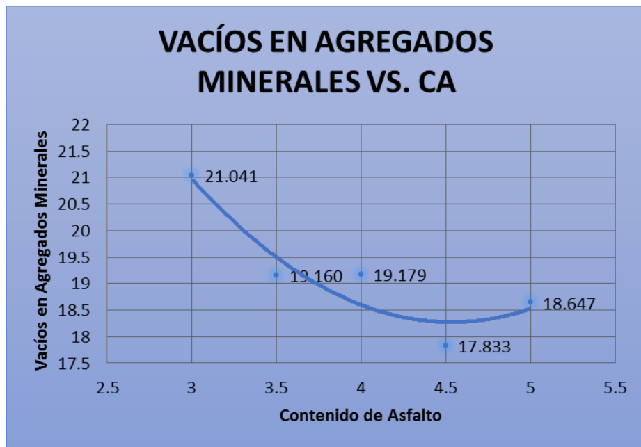
Gráfico N° 16 Porcentaje Vacíos en agregados minerales Vs porcentaje de asfalto (1.5% Fibra acero)
