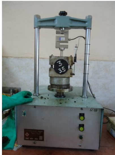
Briqueta ensayada en Máquina Marshall
