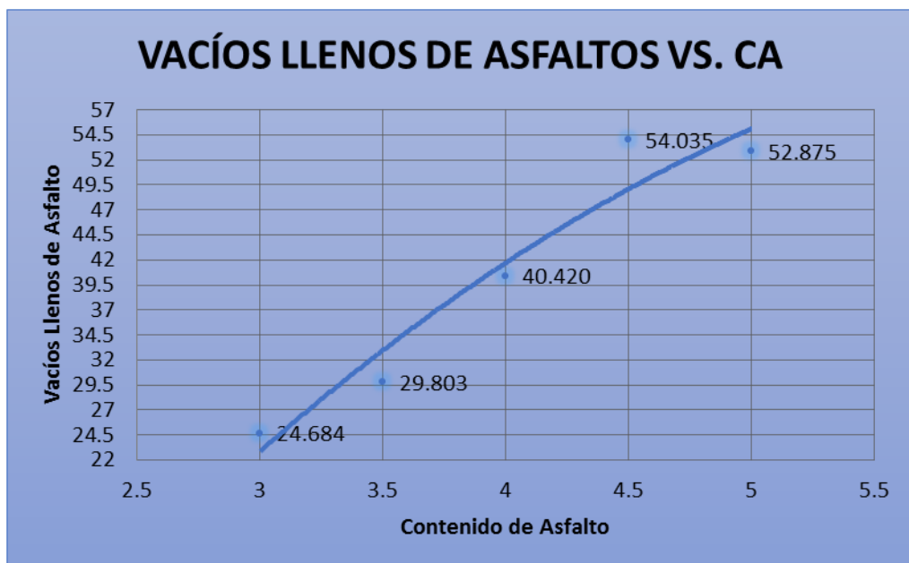
Gráfico N° 23 Porcentaje Vacíos llenos de asfalto Vs porcentaje de asfalto (2% Fibra acero)
