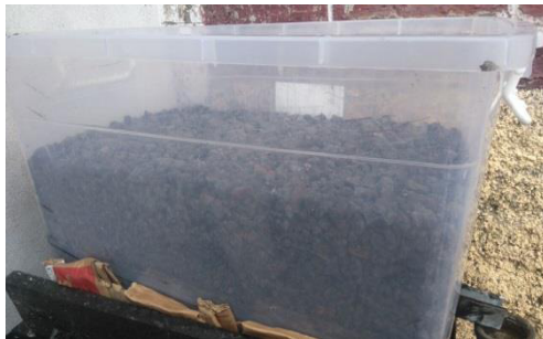
Imagen 5. Colocación del material en el filtro
