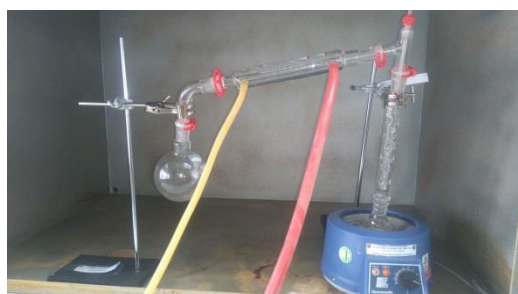
Imagen 24. Proceso de destilado del hexano
