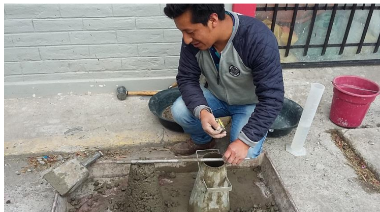
Anexo 6. Ensayo de asentamiento
