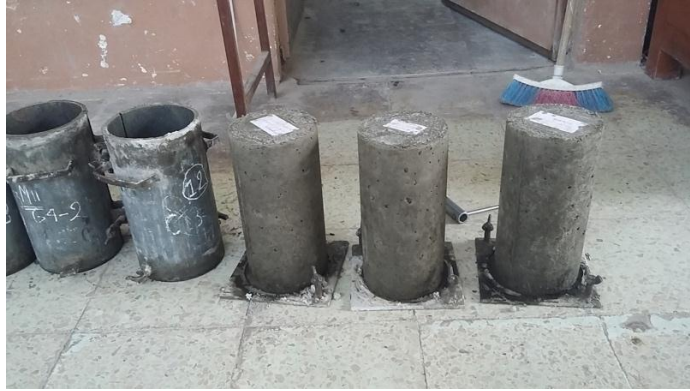
Anexo 10. Desmolde de cilindros de hormigón de 210g/cm 2
