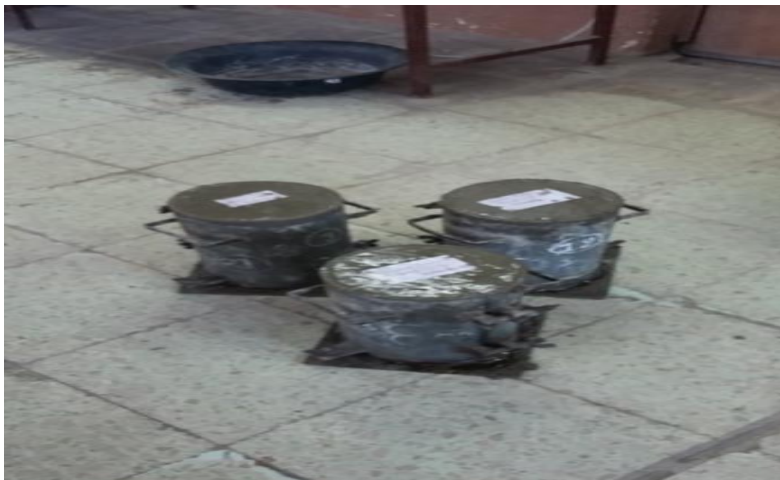
Anexo 9. Preparación de cilindros, hormigón 210gk/cm 2
