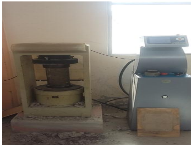
Anexo 12. Ensayo de compresión de los cilindros y verificación de su resistencia
