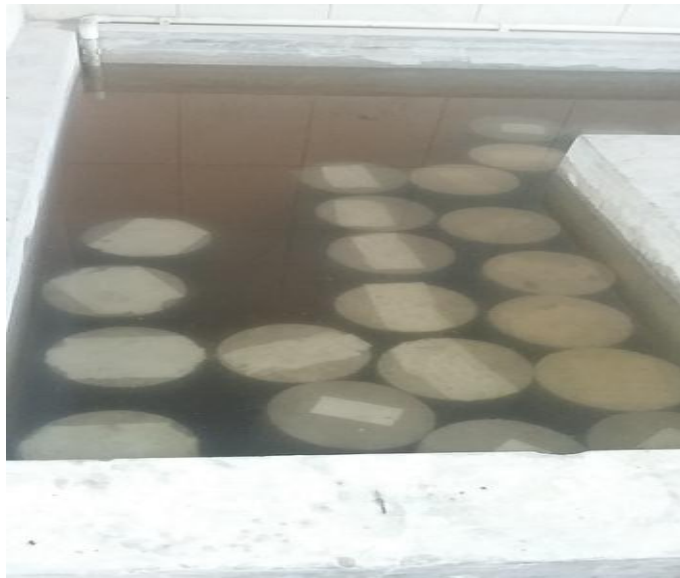
Anexo 11. Curado de cilindros de hormigón para la verificación de la dosificación
