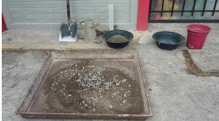
Anexo 4. Dosificación, agregado fino + agregado grueso + cemento
