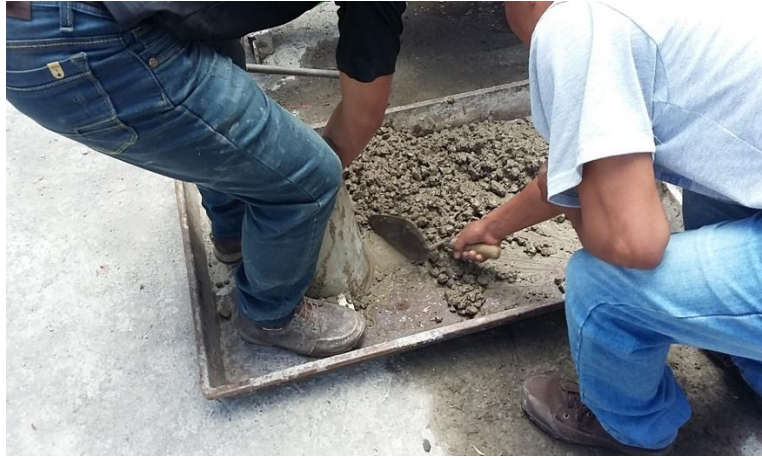
Anexo 7. Ensayo de asentamiento
