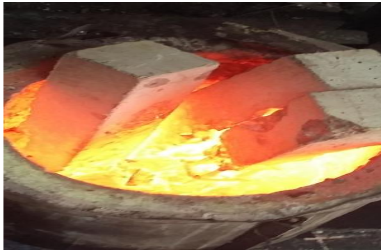
Anexo 20. Quemado de vigas en horno de fundición a diferentes periodos de tiempo
