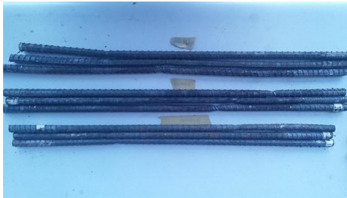
Anexo 23. Preparación e Identificación de probetas de 50cm de largo
