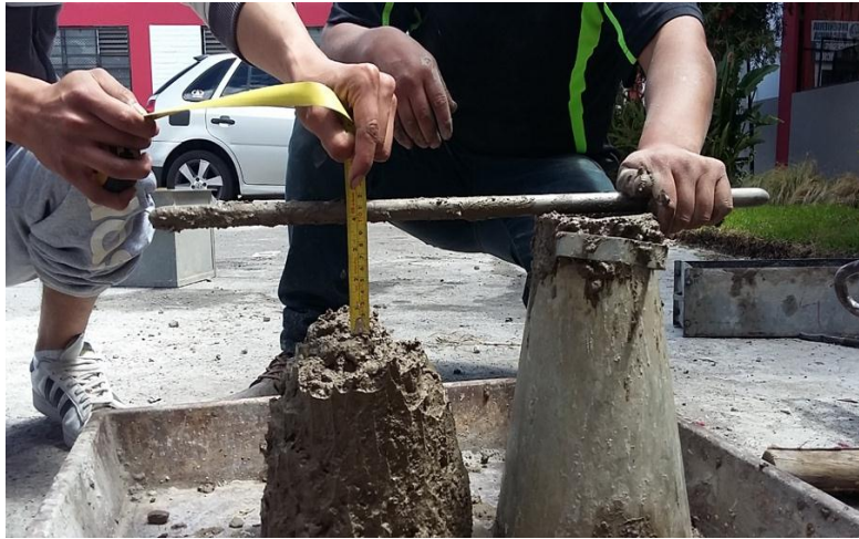
Anexo 8. Verificación del asentamiento para hormigón de 210 kg / cm 2
