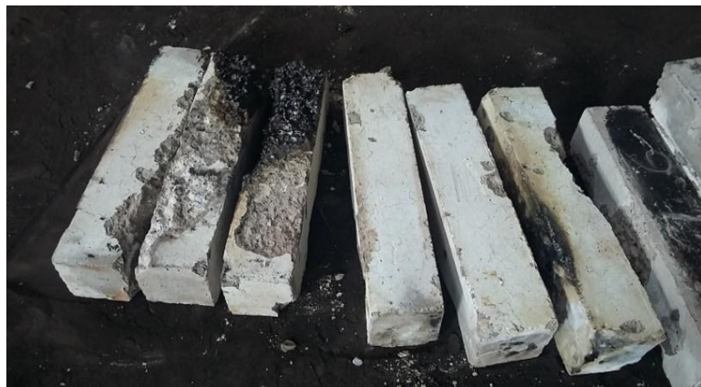
Anexo 21. Enfriamiento de vigas al ambiente en 24 horas
