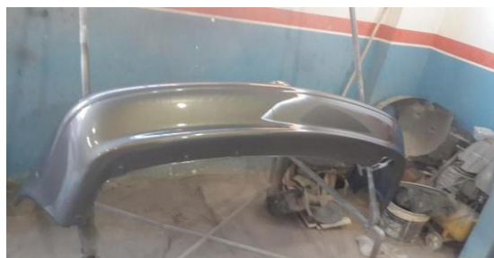
Figura 3.6: Guardachoque posterior barnizado con el producto CS90.
