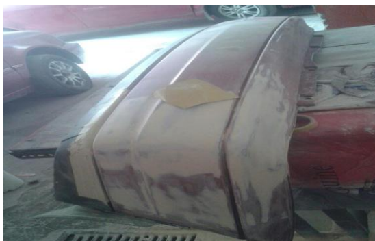
Figura 3.3: Masillado en reparación express de guardachoque plástico con masilla P 35.
