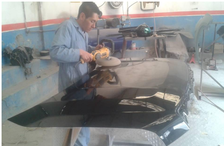
Figura 3.7: Capot en reproceso de pulido.
