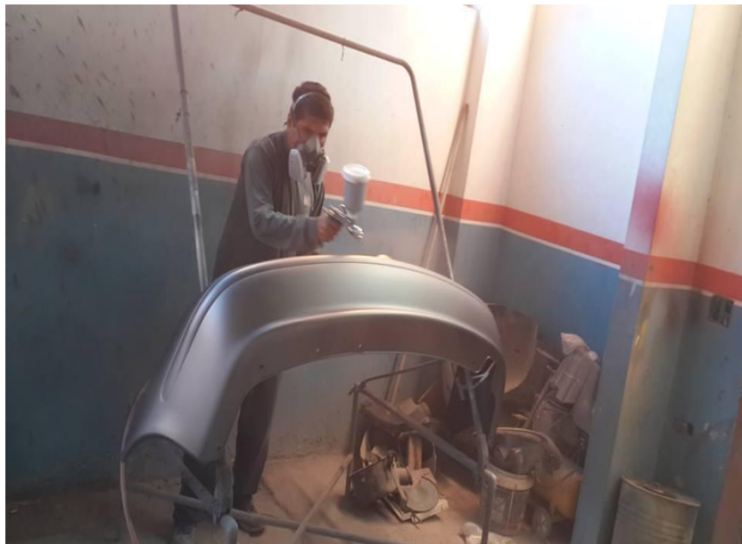
Figura 3. 5: Guardachoque posterior siendo aplicado tinte plata escuna de maxytone.
