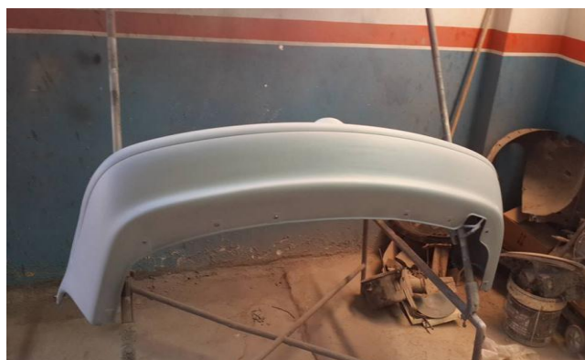
Figura 3.4: Guardachoque posterior fondeado con el aparejo de altos sólidos F54.
