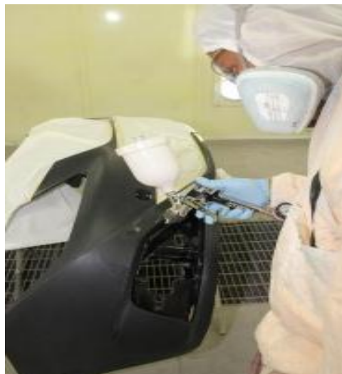
Figura 3.65: Pintura de guardachoque en cámara de secado.
