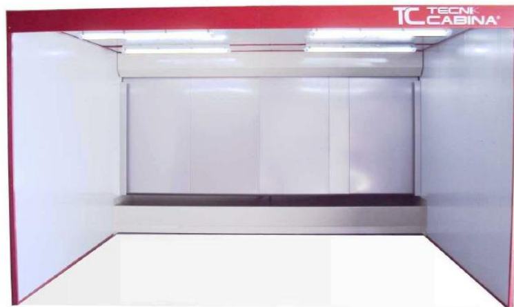
Figura 2.3: Cabina de pintura de cortinas de agua [3].
