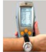
Función logger - Registro de datos en el analizador durante un máximo de 2 horas
