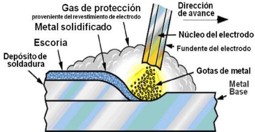
Fig. 9: Esquema de soldadura por arco eléctrico [15].
