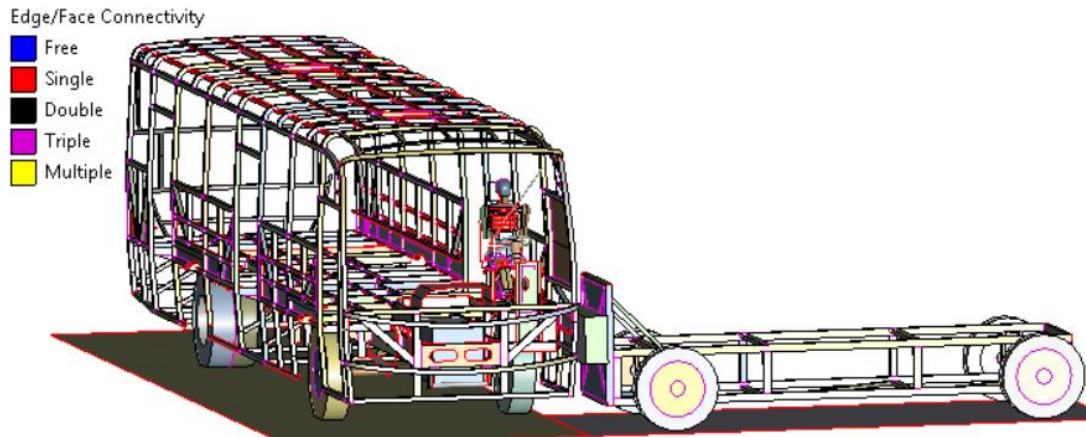
Figura 4. 12. Conectividad del modelo geométrico empleado en el ensayo. (Fuente: Autor.)
