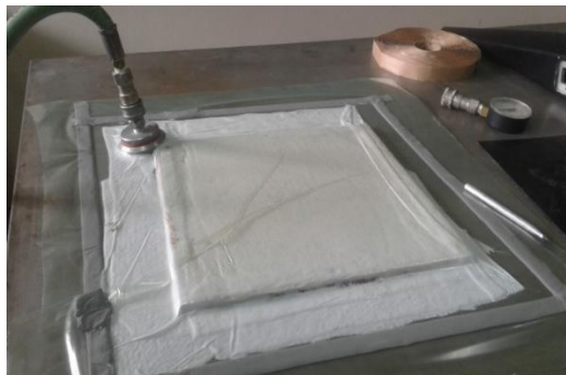
Figura 3.27. Enfundado del material compuesto.
