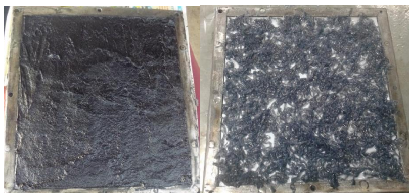
Figura 3.25. Combinación de resina poliéster catalizado y particulado de cuero.
