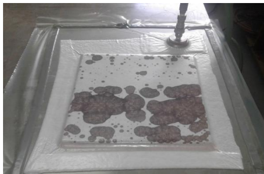
Figura 3.28. Exceso de resina poliéster.
