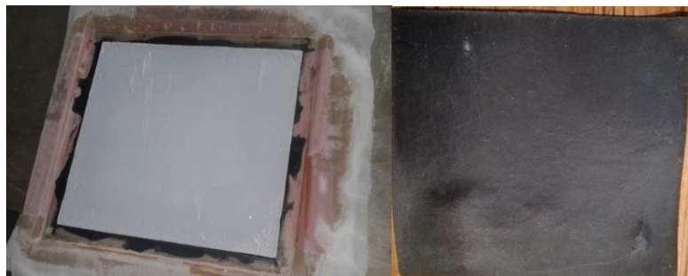
Figura 3.30. Plancha de resina poliéster con refuerzo de particulado de cuero.
