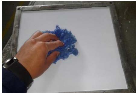
Figura 3.22. Curado del molde de acero A36.
