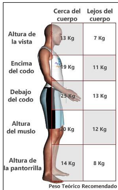
Gráfico N° 11 Peso teórico recomendado en función de la zona de manipulación Fuente: (INSHT I. N., 2011)
