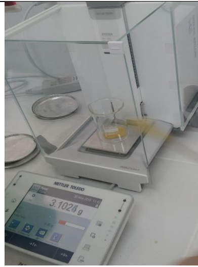
Determinación de peso para medición de acidez
