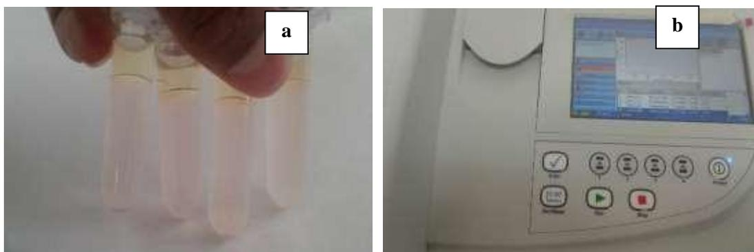
**Ilustración 30.** a) Preparación de muestra – b) Espectrofotómetro (532nm)
