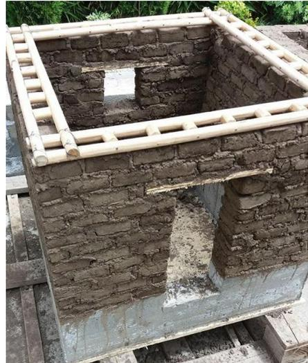
Modelo a escala con viga solera
