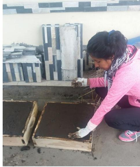
Colocación de la mezcla en los moldes
