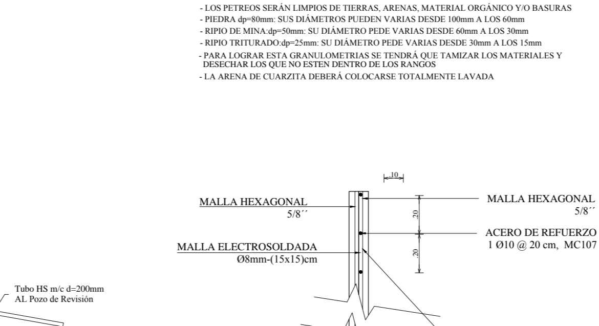
DETALLE FILTRO ASCENDENTE FILTRO - MATERIAL FILTRANTE ESCALA: 5/8
