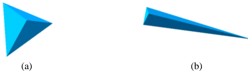
Figura 2.9. Elementos con relación de aspecto (a) cercano a 1, (b) considerable. [14]
