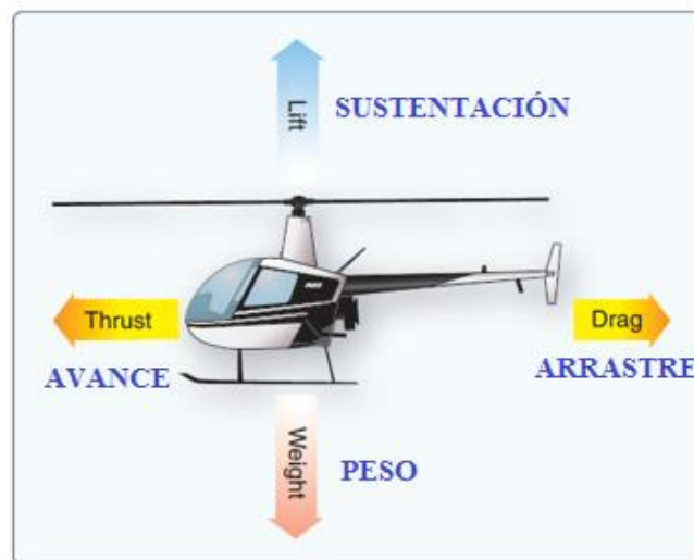
Figura 2.3. Cuatro fuerzas que actúan en un helicóptero [4].
