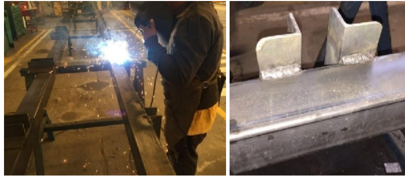
(a) (b) Gráfico 39. Montaje perfil L guías.
