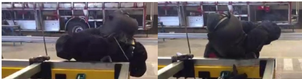
Gráfico 56. Soldado y rematado de tubería perteneciente a plataforma.
