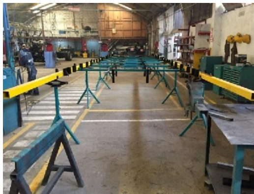
Gráfico 50. Ensamble matriz para anclajes y plataforma.
