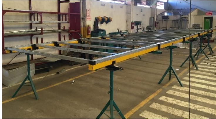
Gráfico 57. Plataforma ensamblada y lista para ser desmontada del Jig.
