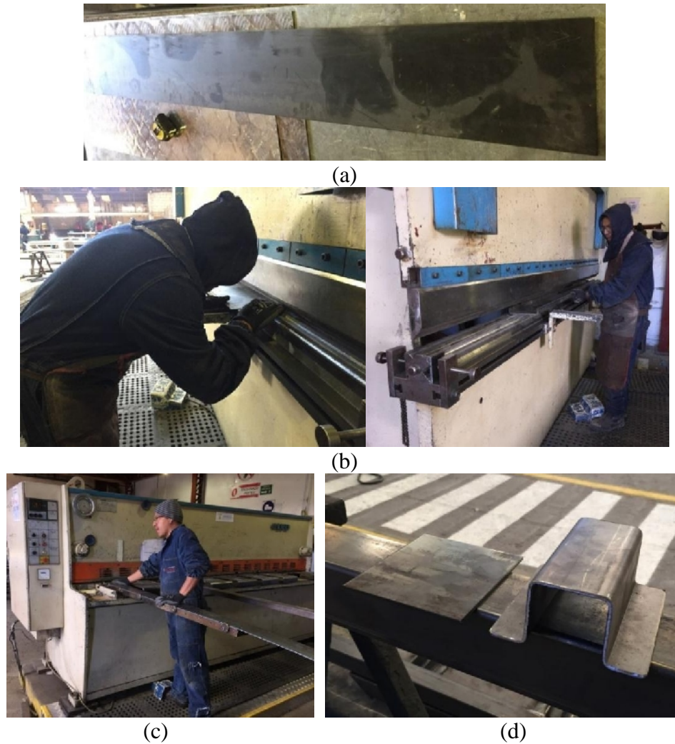
Gráfico 42. Fabricación de placas y omegas de sujeción.
