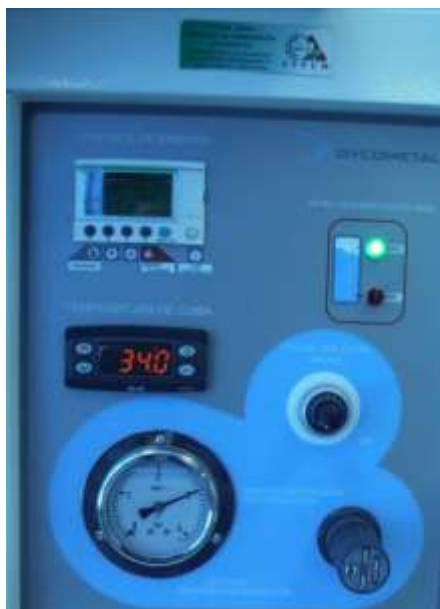
Figura 3-21: Selección de Parámetros para la cámara de niebla salina Fuente: Autor
