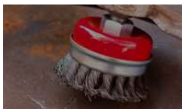
Figura 3-4: Limpieza Mecánica Fuente: Autor
