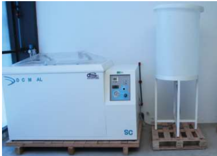
Figura 2-2: Cámara de Niebla Salina Fuente: Autor
