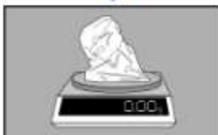
4 Prepare al menos una dilución de 1:10 de la muestra. Pase o pipete la muestra en una funda o bolsa de Stomacher, botella de dilución o cualquier otro contenedor estéril apropiado.
