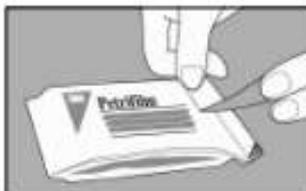
2 Para cerrar un paquete abierto, doble el extremo y sellelo con cinta adhesiva para evitar el ingreso de humedad y, por lo tanto, la alteración de las placas.
