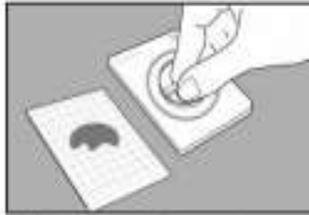
**10** Sujetando el aplicador por la barra superior, colocar el aplicador para Petrifilm levaduras y mohos sobre la placa Petrifilm.
