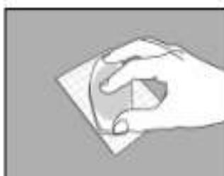
**11** Presione suavemente el dispensador o esparcidor para distribuir la muestra sobre el área circular. No gire ni deslice el dispensador. Recuerde distribuir la muestra antes de inocular una siguiente placa.
