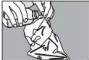
5 Añadir una cantidad adecuada de diluyente. Pueden ser los métodos standard de tampón fosfato, agua peptonada al 0,1 %, triptona sal, agua destilada, solución salina fosfato tamponada o tampón de Butterfield. No utilizar tampones que contengan citrato de sodio o tiosulfato.
