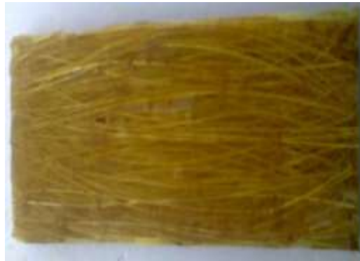
Figura. 18 Probeta preliminar (Resina epóxica + Fibra de abacá.)
