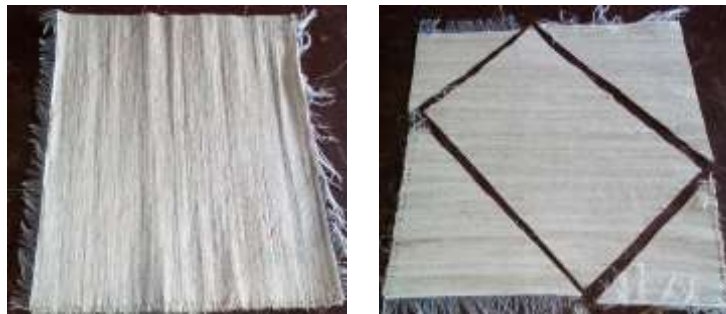
Figura. 30 Tejido sobre dimensionado para orientación de fibras en ángulos de 135° y 45°.
