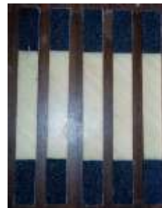
Figura. 39 Probetas de tracción con sobremontas
