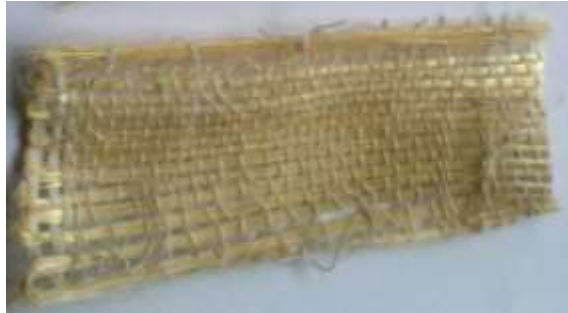
Figura. 19 Tejido preliminar (Fibra de abacá + Fibra de algodón.)
