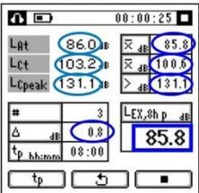
A medida que se van haciendo las mediciones, la aplicación calcula: los promedios energéticos de los  $L_{A1}$  y  $L_{C1}$  medidos, el máximo valor de  $L_{Cpeak}$  y el resultado final de  $L_{EX,8hp}$ . Además de la diferencia entre los valores  $L_{A1}$  medidos. Y los coloca en las casillas del formulario. Estos valores se van actualizando cada vez que se hace una medición. Se pueden hacer tantas como se desee.
