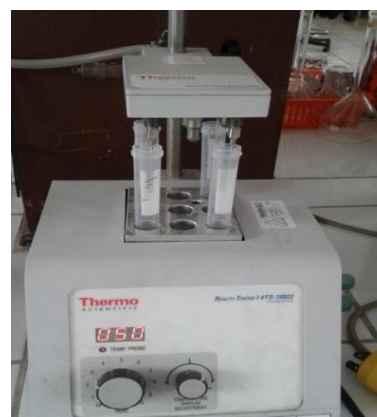
Anexo. 57 Mitad de las muestras se colocaron en la máquina de gas de nitrógeno para secarlas.
