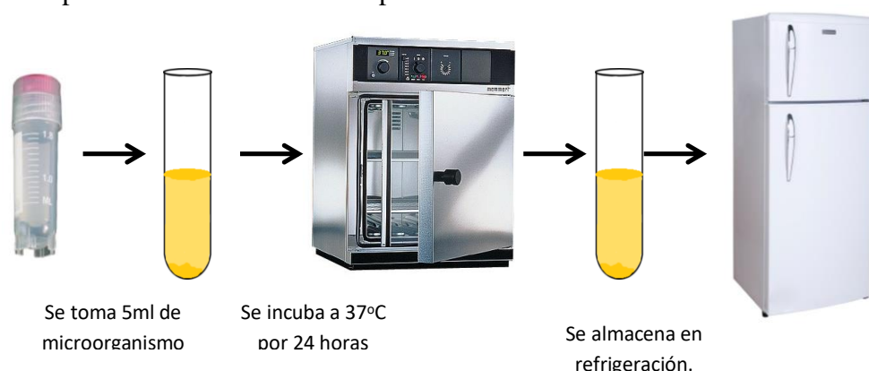
Figura 4. Esquema de la activación de Escherichia. coli a partir de un vial.
