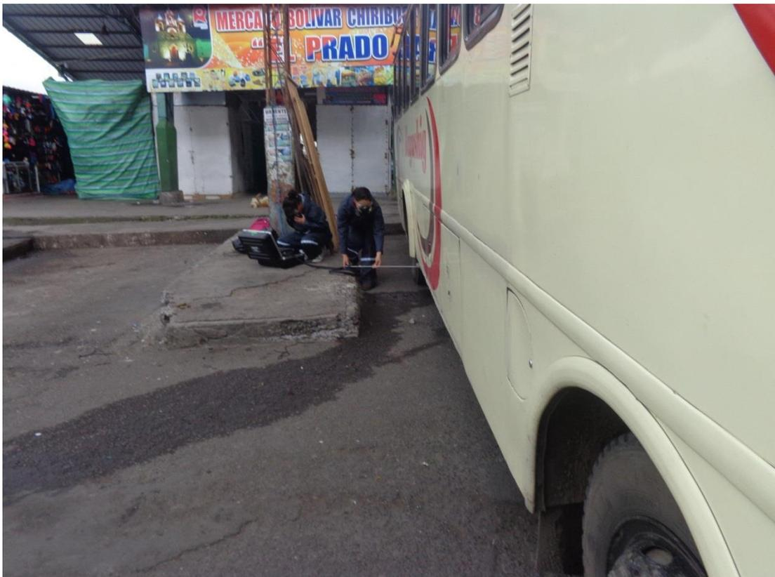
**Figura 23.** Medición de los GEI en vehículos del Terminal de Guano
