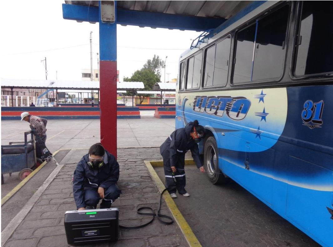
**Figura 22.** Medición de los GEI en vehículos del Terminal Oriental
