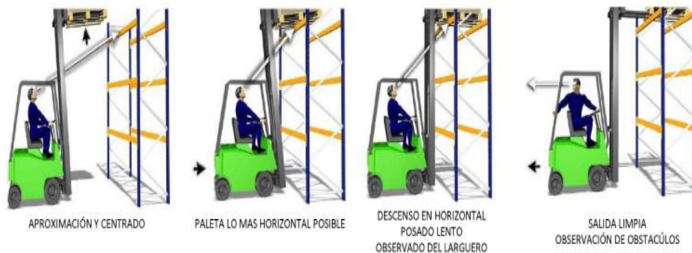
Figura 6-9: Operaciones de carga de la estantería (Estiba).
