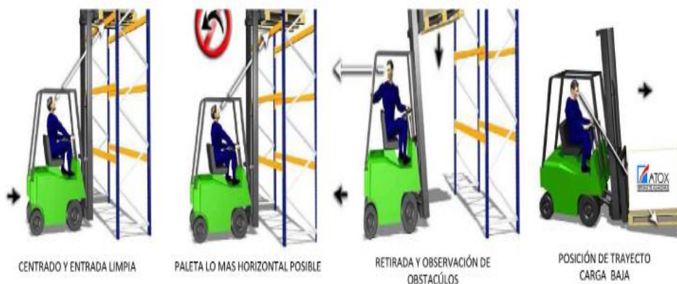
Figura 6-10: Operaciones de carga de la estantería (Desestiba).
