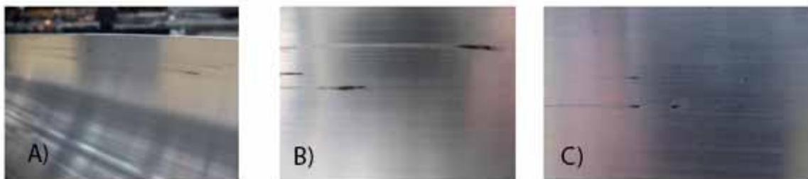
**Figura 2.8 Defectos en la extrubilidad de la aleación 6063; A) Filos cortantes; B) Rayas negras; C) Burbujas**
