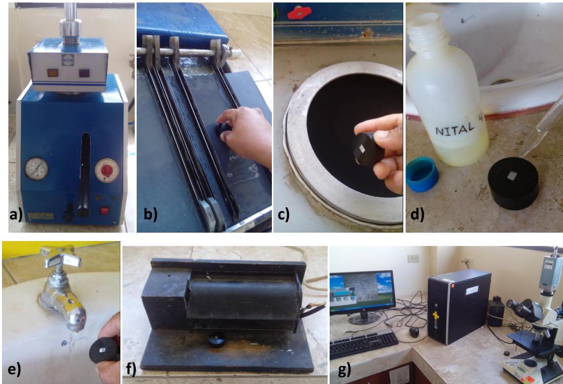
Figura 4. 40. Análisis metalográfico del acero AISI 1045. a) Prensado de probeta en bakelita, b) Lijado manual en lijas 240, 320, 400, 600 y 1500, c) Pulido mecánico en paño a 150 rpm, d) Ataque químico con Nital 2, e) Enjuague en agua de probeta, f) Secado de probeta, g) Análisis en microscopio
