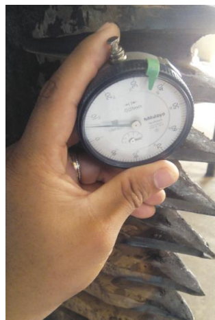
Figura 6. 4. Medición de la rugosidad en los flancos de los dientes del virador
