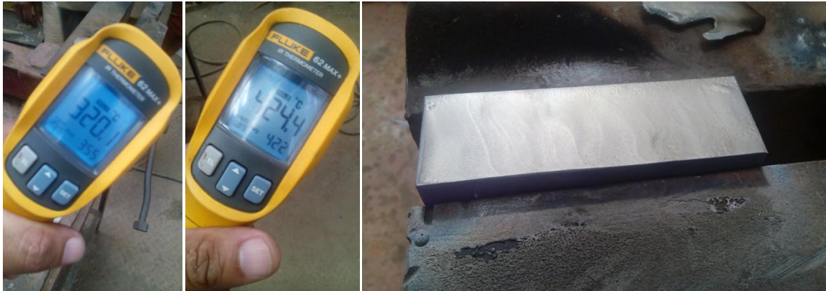
Figura 4. 24. La adherencia del metal pulverizado en la superficie de la probeta por proyección térmica se dio a temperaturas de 320°C y 420°C
