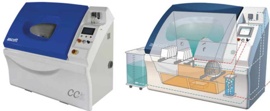
Figura 4. 44. Cámara de niebla salina de la EPN para ensayos de corrosión acelerada
