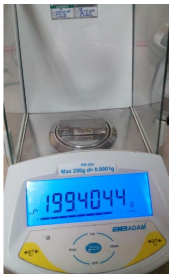
Figura 4. 39. Pesaje de probetas después del ensayo de desgaste por abrasión, con precisión 0.001 g, en balanza de precisión ADAM
