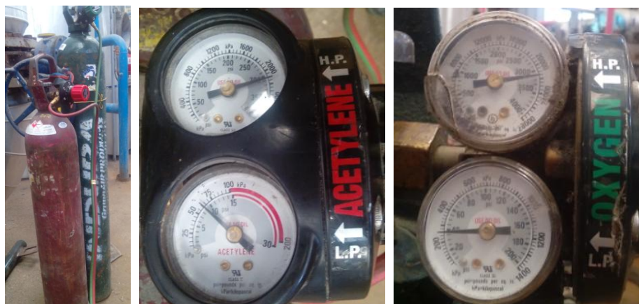
Figura 4. 20. Configuración de la presión de gases para el proceso de proyección térmica, acetileno a 9 PSI y oxígeno a 37 PSI
