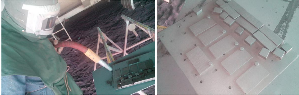
Figura 4. 12. Proceso de granallado metálico en probetas
