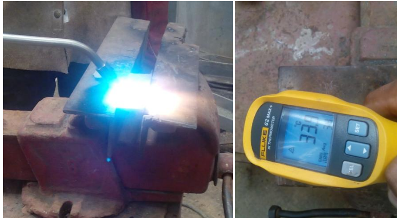
Figura 4. 22. Control de temperatura de precalentamiento en la superficie de las probetas mediante el uso de un termómetro láser FLUKE 62MAX+
