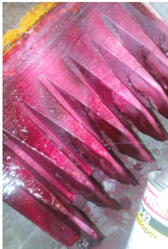
Ilustración 2. Ensayo por líquidos penetrantes en dientes del virador
