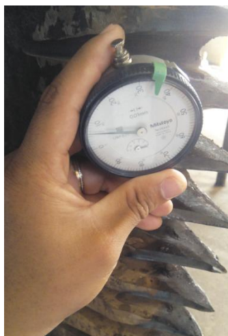
Figura 4. Medición de la rugosidad en los flancos de los dientes del virador Fuente: Autor
