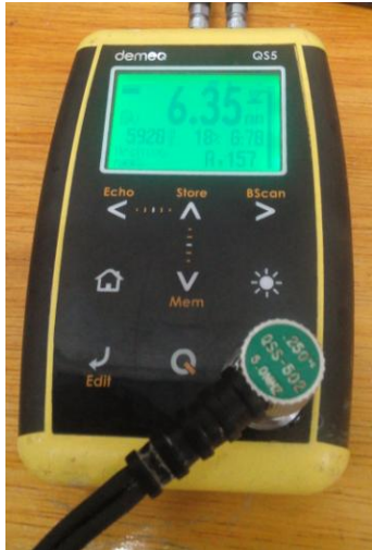
Figura 4. 28. Calibración del medidor de espesores por ultrasonido DEMAQ QS5
