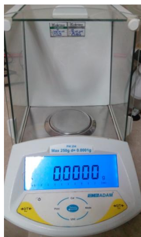
Figura 4. 30. Registro de pesos de probetas en balanza de precisión ADAM, antes de los ensayos de desgaste por abrasión y corrosión acelerada
