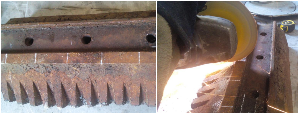
Figura 4. 1. Extracción de muestras de acero AISI 1045 de un virador de molino de caña para la fabricación de probetas
