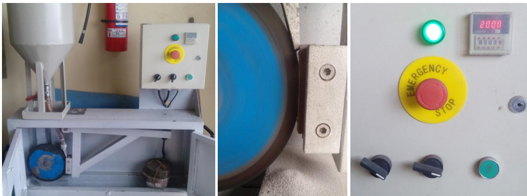
Figura 4. 37. Ensayo de desgaste por abrasión según el procedimiento B de la ASTM G-65
