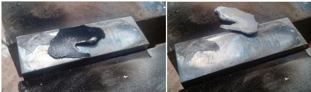
Figura 4. 23. La temperatura de precalentamiento (200°C) en la probeta no fue suficiente para conseguir la adherencia del metal de aporte con la superficie
