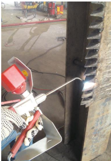
Figura 8. Aplicación del blindaje en los flancos de los dientes del virador Fuente: Autor
