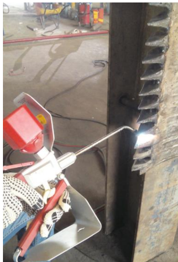
Figura 6. 8. Aplicación del blindaje en los flancos de los dientes del virador
