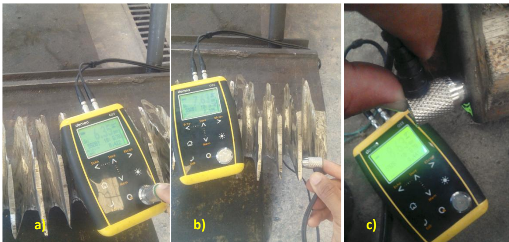
Figura 6. 9. Medición de espesor en los flancos de los dientes del virador, a) calibración en cero del equipo, b) medición antes del blindaje, c) medición después del blindaje
