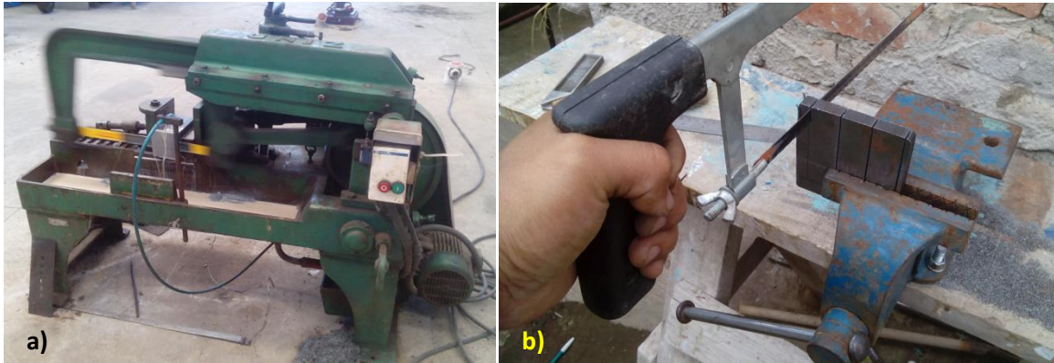
Figura 4. 2. Fabricación de probetas mediante el uso de: a) Sierra eléctrica de vaivén, b) Sierra manual
