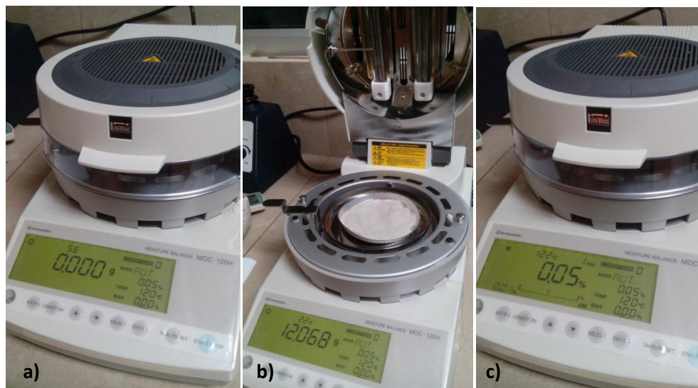
Figura 4. 35. Proceso de medición de humedad. a) Calibración en cero del equipo, b) pesaje de muestra, c) registro del valor de humedad
