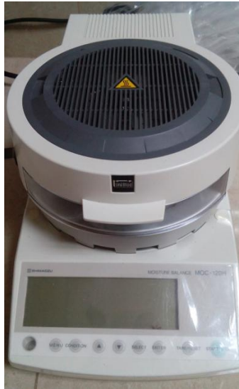
Figura 4. 34. Equipo de medición de balance de humedad SHIMADZU MOC-120H
