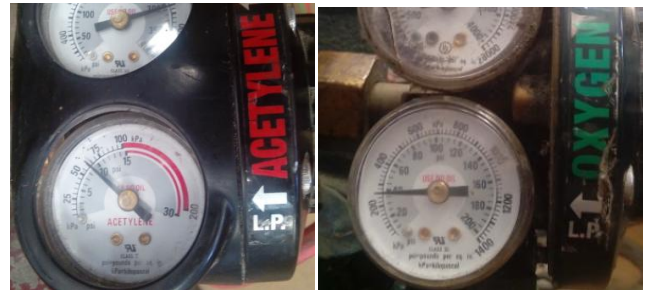
Figura 6. Presiones configuradas para los gases, oxígeno y acetileno
