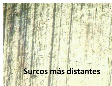
Figura 4. 72. Huella de desgaste abrasivo en la probeta con blindaje y preparación de superficie por sandblasting, imagen microscópica a 100X
