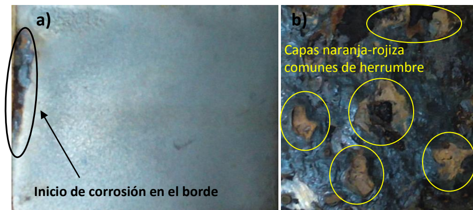
Figura 4. 77. Probetas expuestas a 200h de corrosión acelerada, a) Corrosión por grietas en el borde de probeta C8, b) Corrosión uniforme en sustrato
