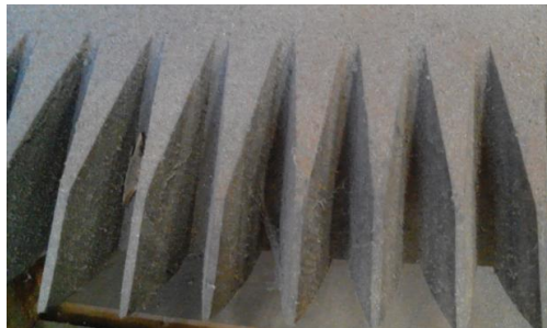
Figura 6. 3. Flancos de los dientes del virador después del sandblasting
