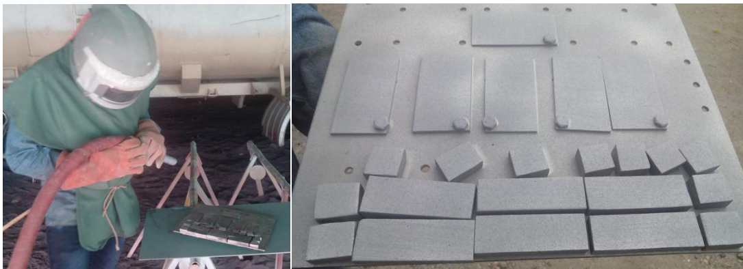
Figura 4. 9. Proceso de sandblasting mineral en probetas
