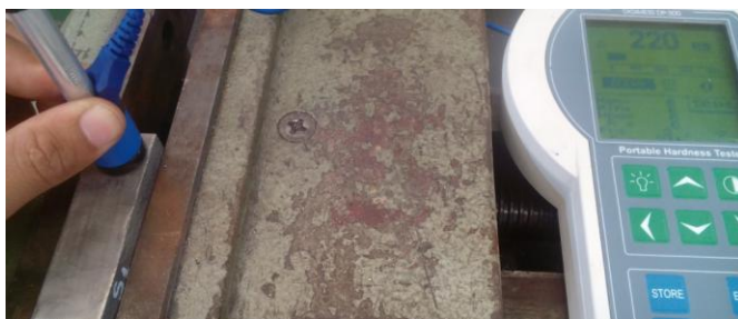
Figura 4. 26. Registro de dureza Brinell en probetas después del proceso de blindaje
