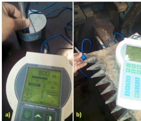
Figura 10. Medición de dureza brinell en blindaje, a) Calibración del equipo, b) Registro de dureza brinell
