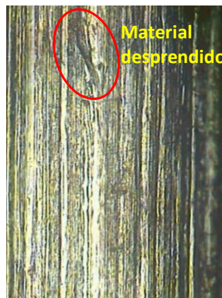
Figura 4. 70. Huella de desgaste abrasivo en el sustrato, imagen microscópica a 100X
