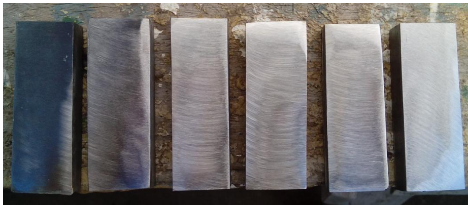
Figura 4. 5. Probetas para ensayo de desgaste por abrasión preparadas superficialmente mediante pulido mecánico
