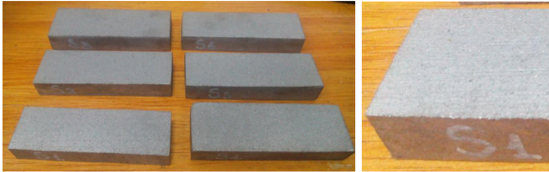
Figura 4. 10. Probetas con preparación superficial por sandblasting para ensayo de desgaste por abrasión
