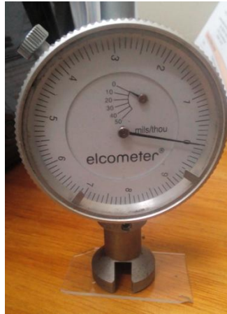
Figura 4. 14. Calibración del medidor de rugosidad ELCOMETER 123 sobre un patrón de vidrio de rugosidad cero
