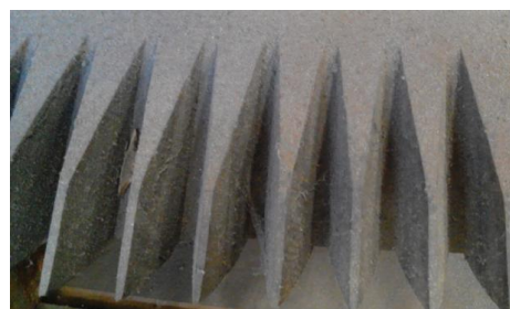
Figura 3. Virador después del proceso de sandblasting Fuente: Autor
