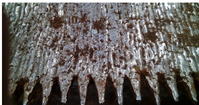
Figura 2. 9. Huellas de desgaste del virador del molino 1 (vista superior)
