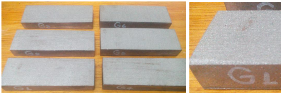
Figura 4. 13. Probetas con preparación superficial de granallado metálico para ensayo de desgaste abrasivo
