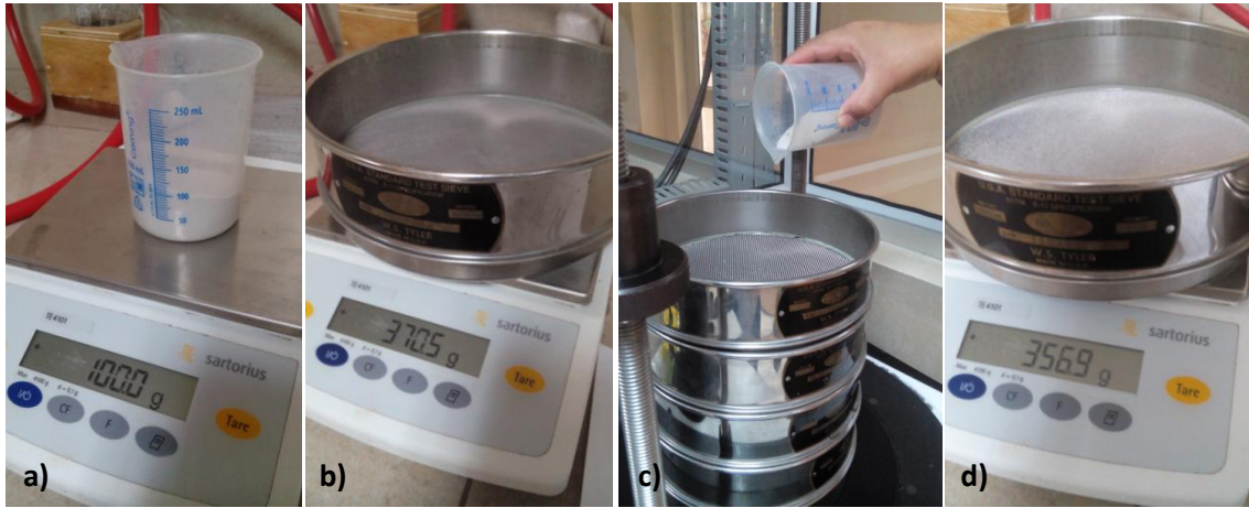
Figura 4. 33. Análisis de granulometría en equipo WS TYLER RX-812 según ASTM E11. a) Pesaje de 100 g de muestra, b) pesaje de tamices vacíos, c) vibración de muestra durante 20 min, d) pesaje de tamices con el producto retenido
