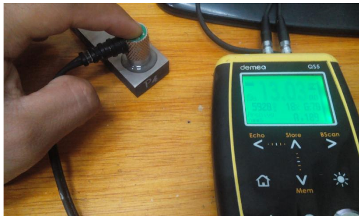
Figura 4. 29. Medición de espesor de blindaje en probetas
