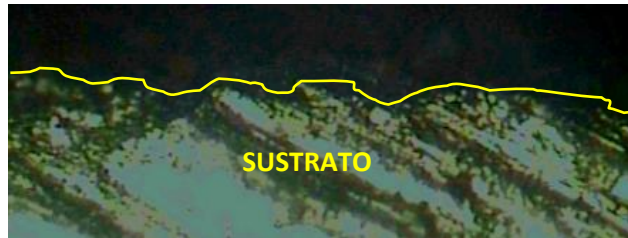
Figura 4. 54. Perfil de acabado superficial por granallado metálico (Microscopia a 100X)
