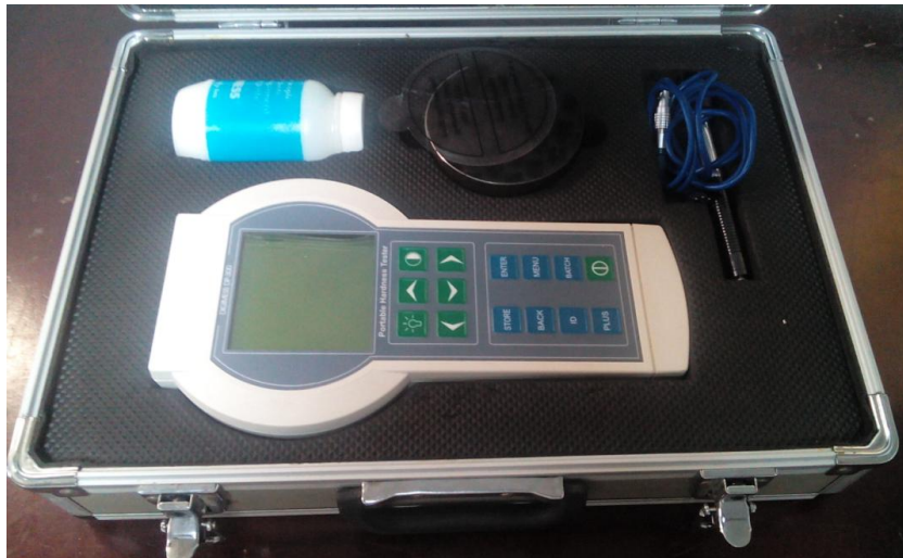
Figura 4. 16. Equipo profesional de medición de dureza DIGIMESS DP 300
