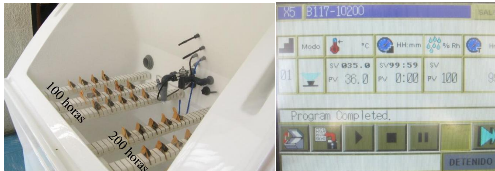
Figura 4. 45. Ubicación de las probetas dentro de la cámara de niebla salina y configuración del panel
