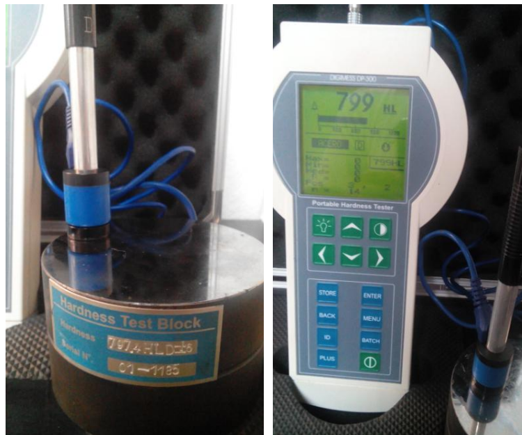
Figura 4. 17. Calibración del equipo de medición de dureza DIGIMESS DP 300. El patrón indica una dureza de 797.4 HL \pm 5, la medida tomada muestra 799 HL
