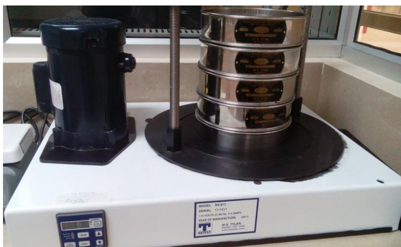
Figura 4. 31. Equipo para granulometría WS TYLER RX-812 según ASTM E-11
