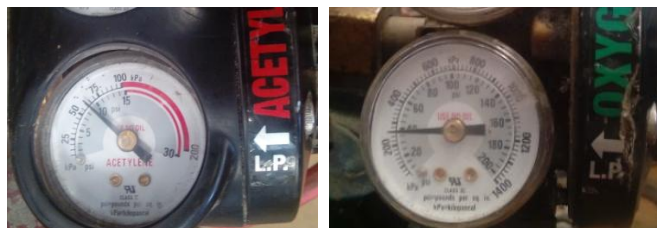
Figura 6. 6. Presiones configuradas para los gases, oxígeno y acetileno
