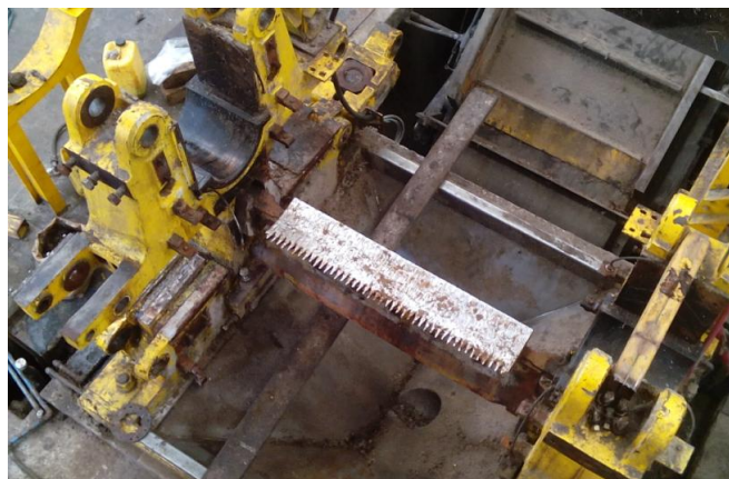
Figura 2. 3. Virador o cuchilla central de un molino de caña
