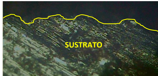
Figura 4. 52. Perfil de acabado superficial por sandblasting (Microscopía a 100X)
