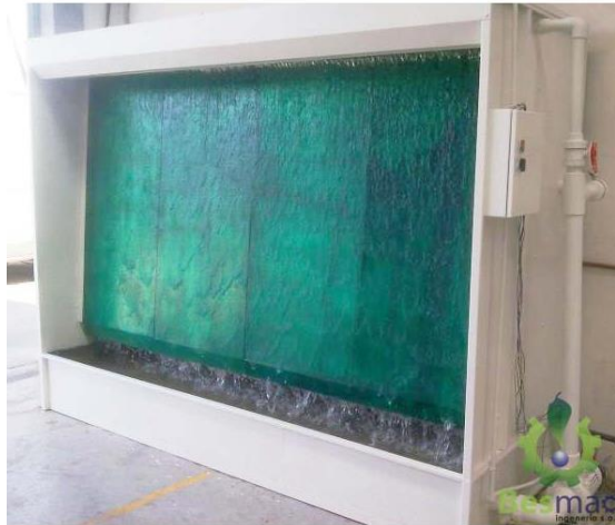
Figura 6.2. Cabina con cortina de agua, suministrada por la empresa Besmac Ingeniería S.A.S.
