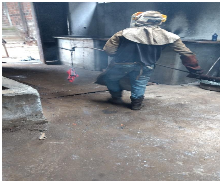
Figura C.2: Piezas elaboradas en el horno de tratamiento térmico
