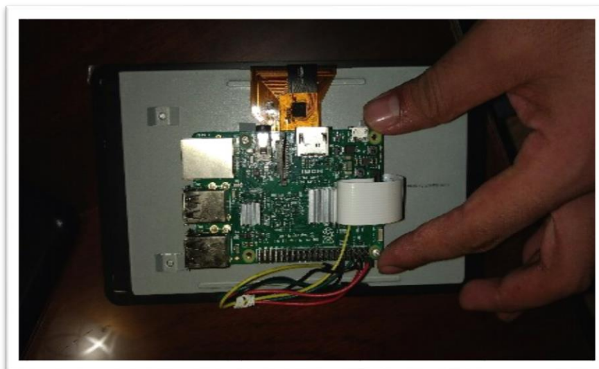
Figura 4. 29: Conexión entre la pantalla LCD y la Raspberry Elaborado por Investigador
