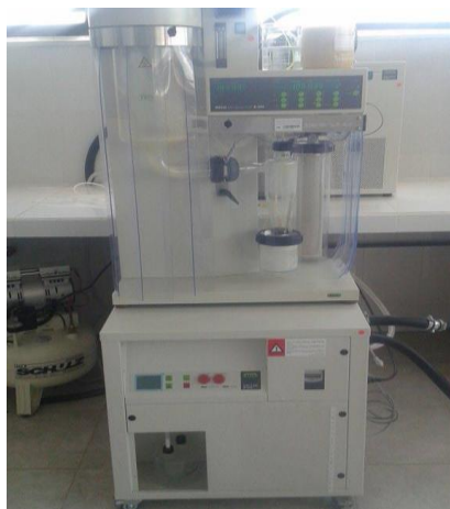
Figura 14. Secado del hidrolizado en Spray Dryer
