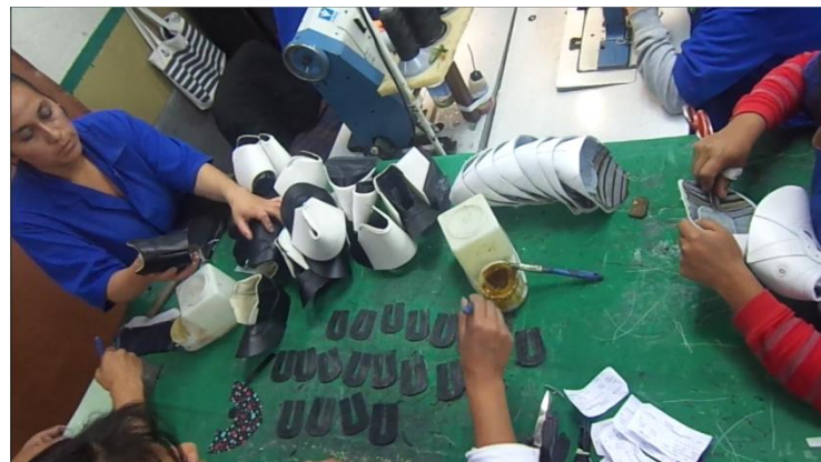
Fig. 13. Preparado de cortes para el armado
