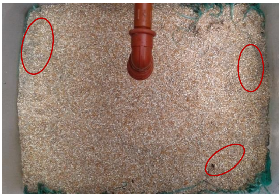
Imagen 10. Retención de partículas en el carbonato de calcio
