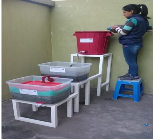
Imagen 13. Colocación del agua residual en el filtro artesanal
