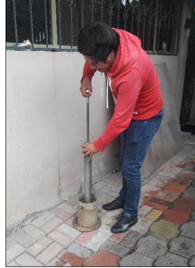
Ensayo de compactación.
