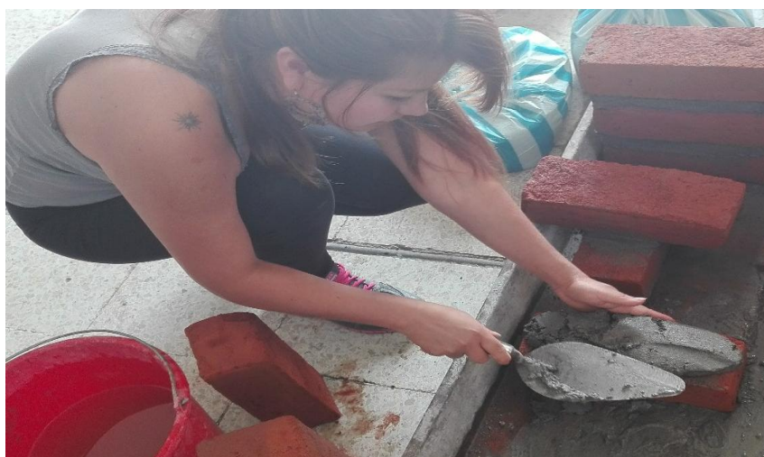
Imagen No.11 Construcción del prisma de Mampostería y muestra de adherencia
