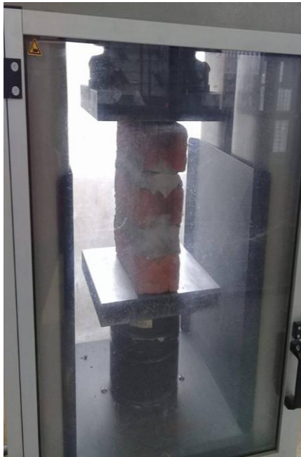
Imagen No.18 Ensayo de la Mampostería.
