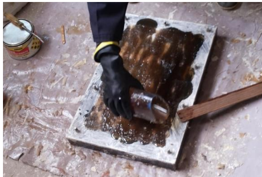
Figura 3. 23: Colocación de la mezcla en el molde. (Fuente: El Autor)
