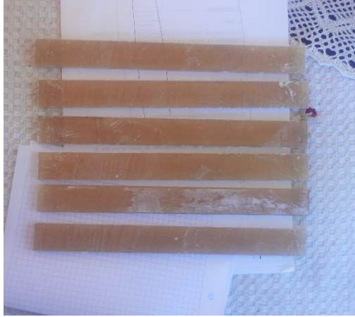
Figura 3. 29: Probetas para ensayos de tracción cortadas bajo las especificaciones de la norma ASTM D3039-00. (Fuente: El Autor)
