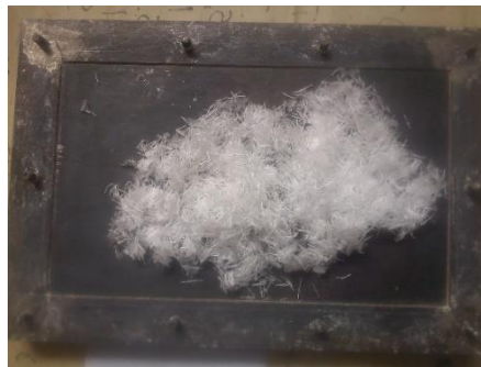
Figura 3. 18: Colocación de la fibra corta de PET en el molde. (Fuente: El Autor)
