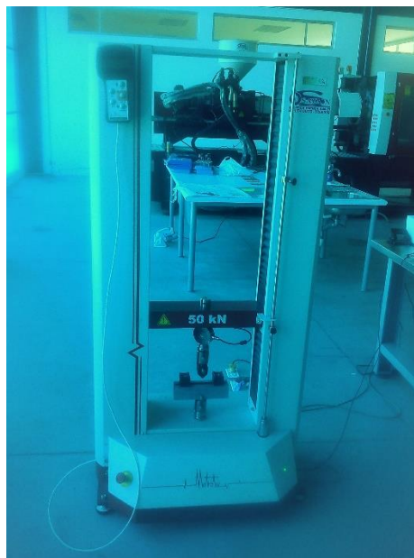
Figura 3. 32: Máquina Universal de Ensayos Electromecánicas MTE-10/50. (Fuente: El Autor)
