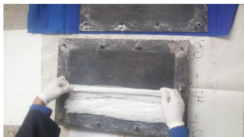
Figura 3. 19: Colocación de la fibra larga de PET en el molde. (Fuente: El Autor)
