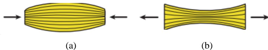
Figura 2. 1. Material expuesto a: (a) cargas compresivas, (b) expuesto a tracción. [11]
