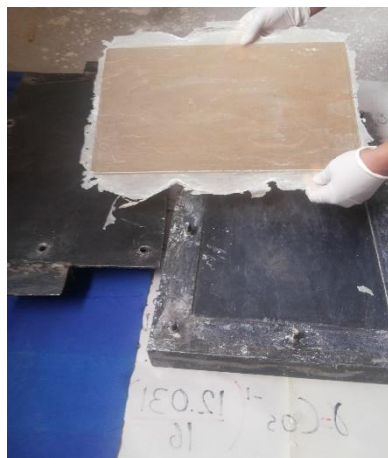
Figura 3. 26: Desmolde del material compuesto. (Fuente: El Autor)
