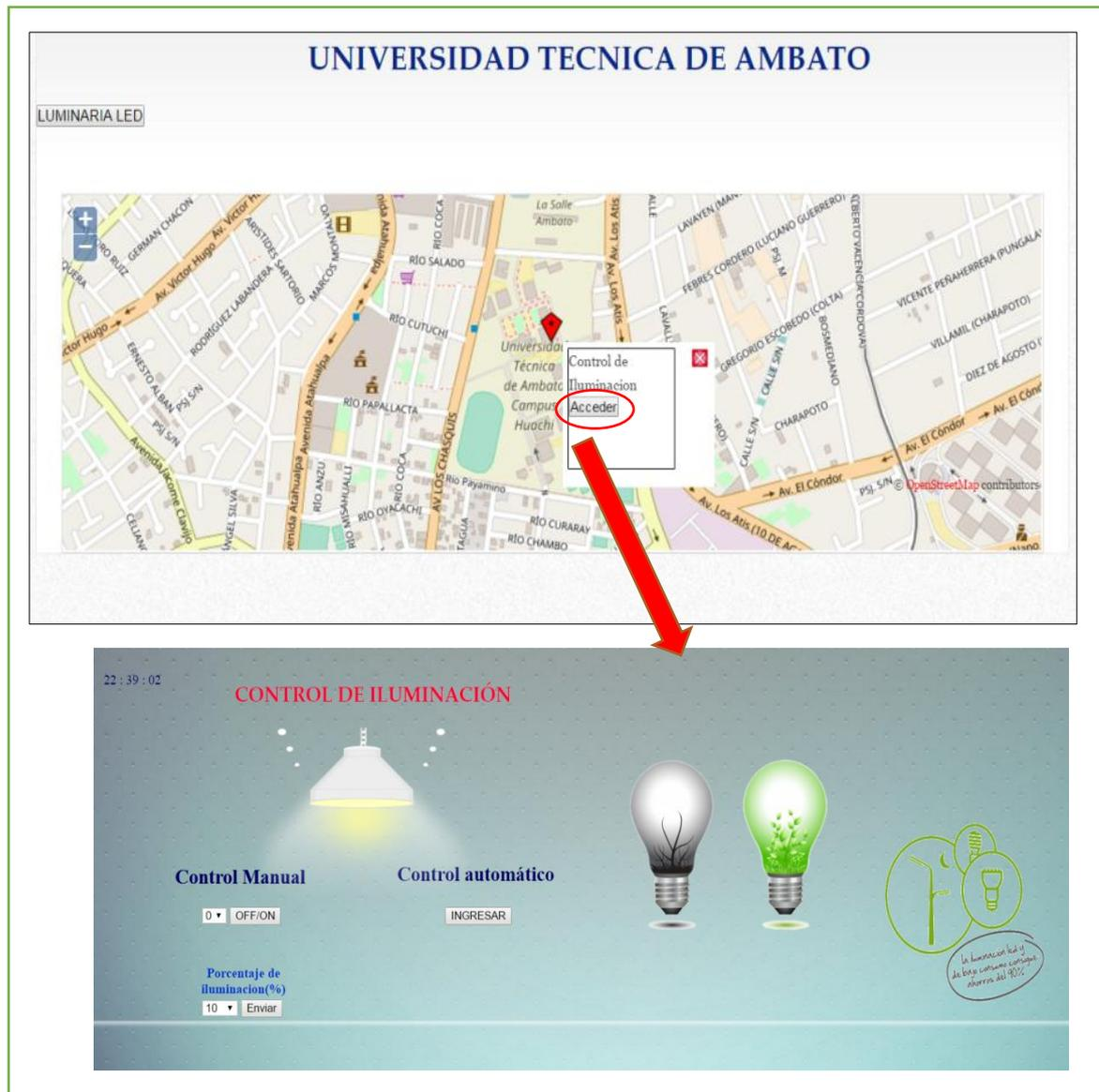
Figura 4.40: Interfaz web de localización geográfica de la luminaria integrada al control de iluminación [Autor].
