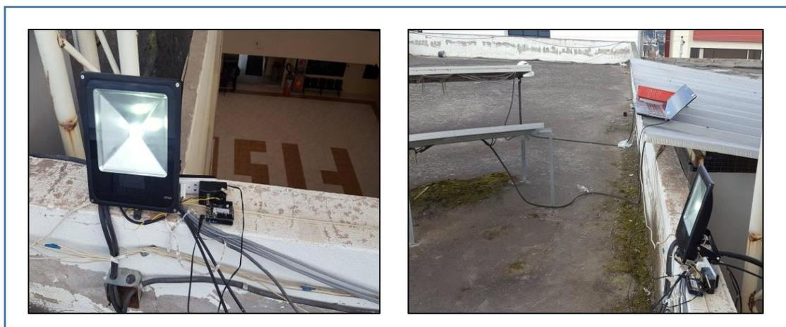
Figura 4.39: Pruebas de funcionamiento del sistema de control integrado a una luminaria LED, alimentado con un sistema fotovoltaico [Autor].
