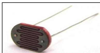
Figura 4.28: Modelo de una fotorresistencia [66]
