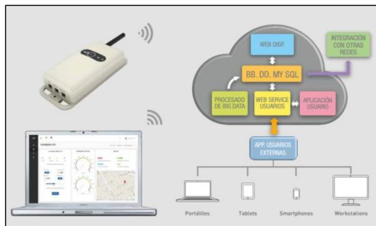
Figura 2.17: Esquema de funcionamiento del sistema de control remoto e3light [30].
