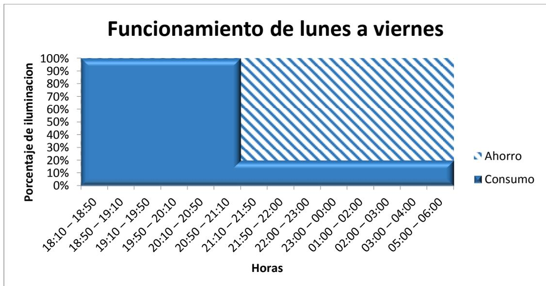
Figura 4.35: Esquema de funcionamiento del sistema de control de lunes a viernes [Autor].
