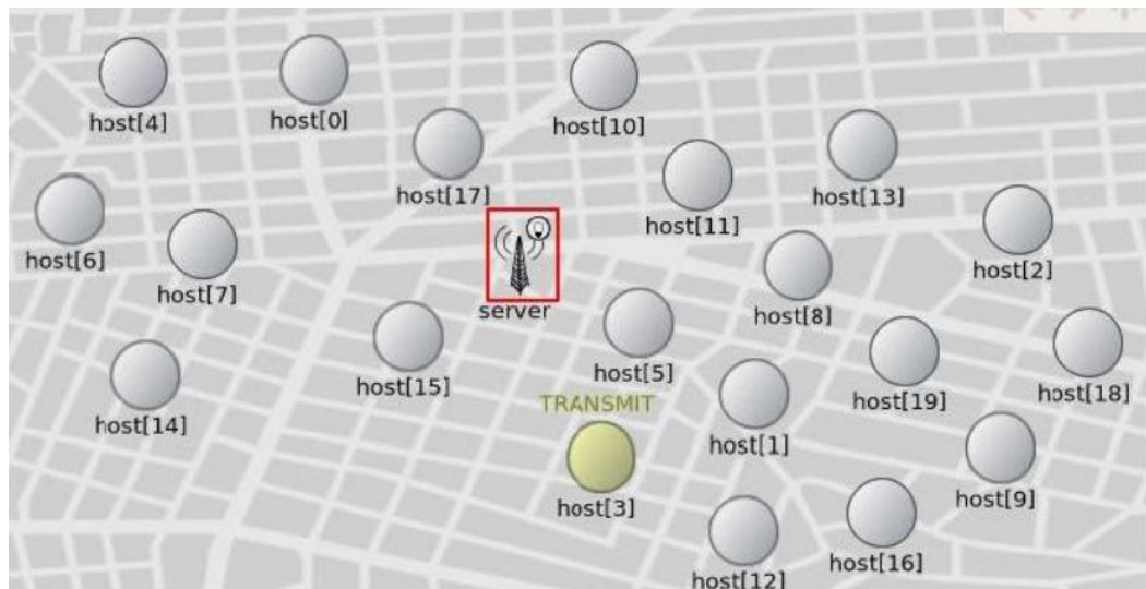
Figura 4.6: Topología simulada de la red de sensores en OMNET++ 4.
