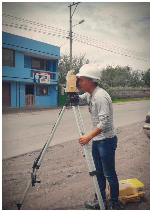
Foto N° 1: Realizando el levantamiento topográfico utilizando la estación total
