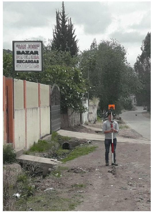
Foto N° 2: Ubicando el prisma para realizar el registro de viviendas
