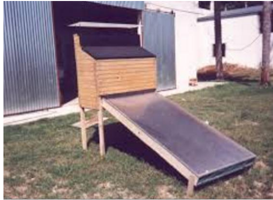
Figura N° 3. 2: Deshidratador solar indirecto Fuente: (Moreno G., 2013)[6]
