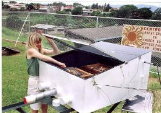
Figura 4.3 Deshidratador solar mixto Fuente: (Moreno G., 2013)
