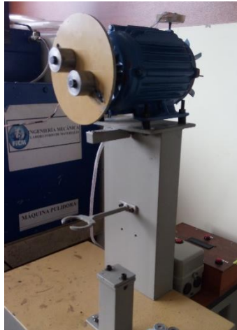
Figura 3. 20: Banco de prueba con masas excéntricas grandes con h=37\text{mm} .
