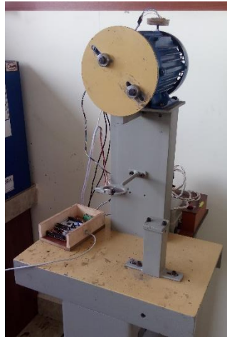
Figura 3. 25: Banco de prueba con masas excéntricas pequeñas con h=24\text{mm} .
