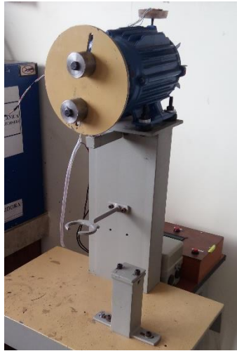
Figura 3. 21: Banco de prueba con masas excéntricas grandes con h=22\text{mm} .
