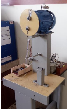
Figura 3. 23: Banco de prueba con masas excéntricas pequeñas con h=43\text{mm} .
