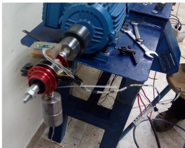
Figura 3. 76: Medición de vibraciones en banco de pruebas “Máquina para pruebas de fatiga por rotación”.
