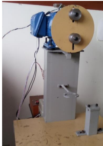
Figura 3. 22: Banco de prueba con masas excéntricas grandes con h=15\text{mm} .
