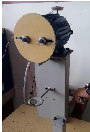
Figura 3. 24: Banco de prueba con masas excéntricas pequeñas con h=35\text{mm} .
