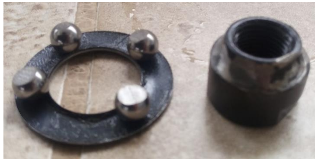
Figura 3. 75: Rodamiento y pista en mal estado.
