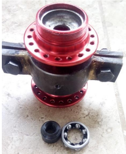
Figura 3. 74: Rodamiento y pista en buen estado.
