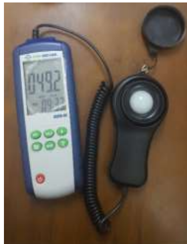
Fig. 16 Luxómetro digital DIGI-SENSE
