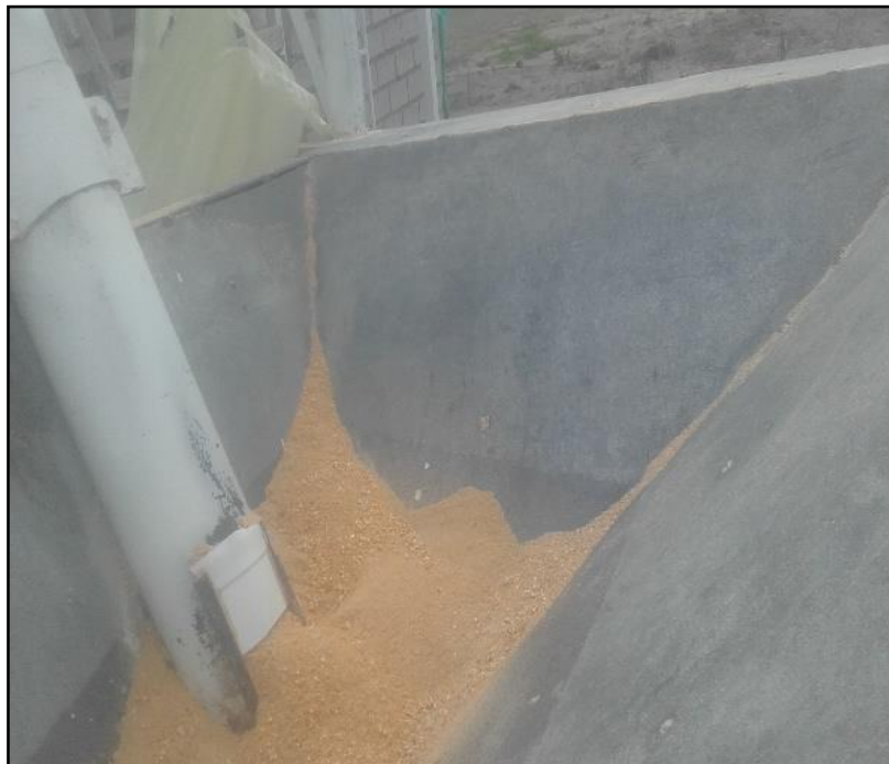
Fig. 15. Elevación del balanceado al silo. Fuente: Compañía Productora Avícola Cajamarca Suárez “Cavimente” Cía. Ltda. Elaborado por: El investigador.
